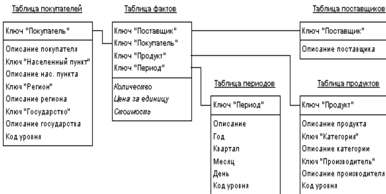
Рис. 8. Пример схемы «звезда»
