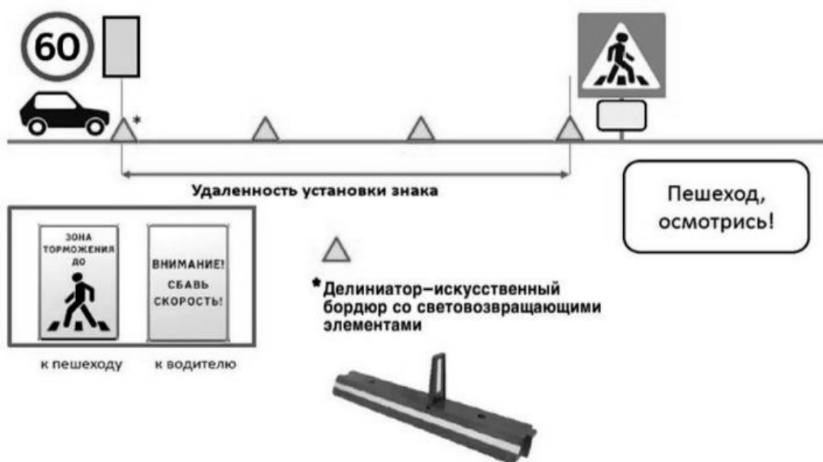
Рис. 3 – Установка знака в точке невозврата (технически упрощенное решение)
