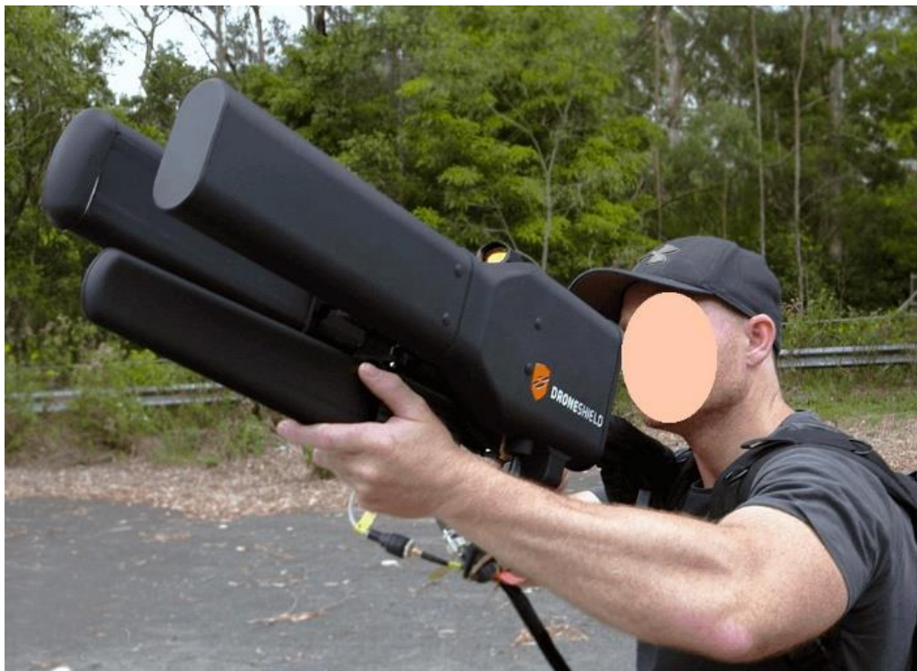
Рис. 3. Постановка радиопомех для нарушения навигации беспилотных воздушных судов
