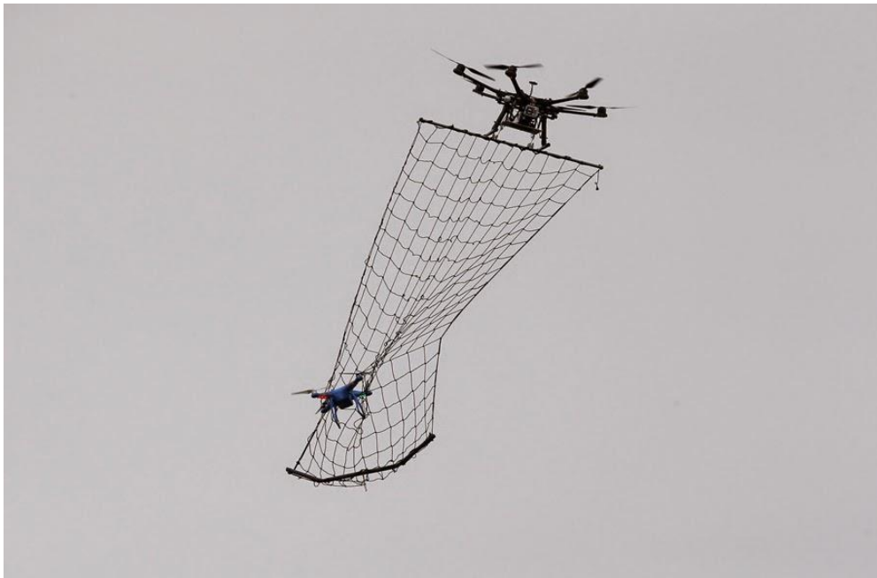
Рис. 2. Захват одного дрона другим при помощи специальной сетки-ловушки
