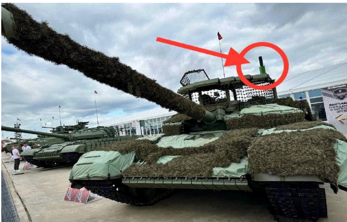
Рис. 11. Установленная на танке защита от вертикальных сбросов с FPV-дронов-камикадзе, а также комплекс подавления беспилотников «Тритон»
