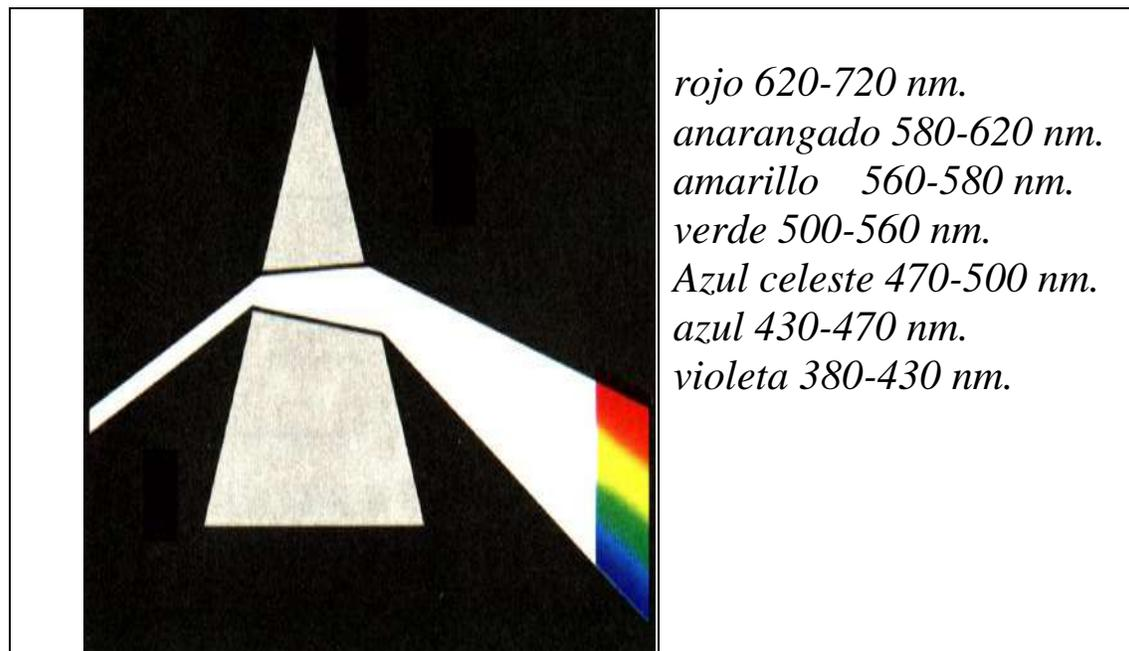
Dibujo. 2. Descomposición de la luz en un prisma de vidrio en espectros continuos de rayos de colores
