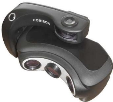
Fig. 22.4. Three-lens panoramic digital camera «HORIZON» D-L3
