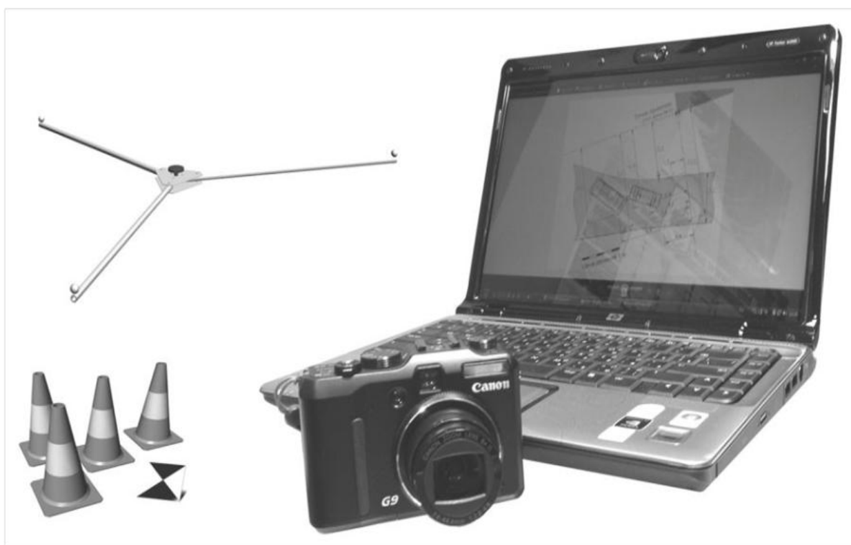
Fig. 38. Photogrammetric device «FOMP-K»
