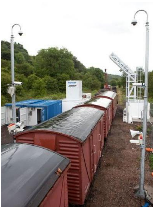
Рис. 2.32. Рельсовый инспекционно-досмотровый комплекс Eagle R90
