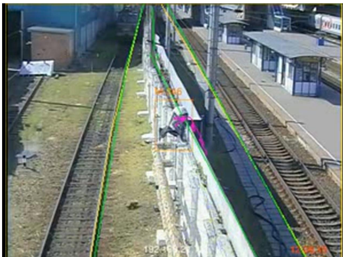
Рис. 1.4. Обнаружение преодоления ограждения
