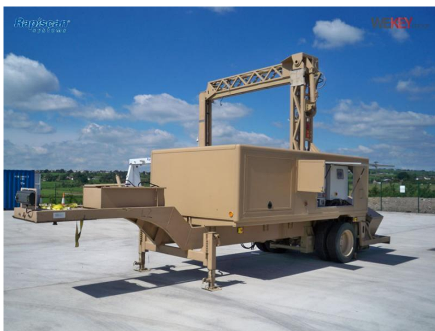
Рис. 2.34. Инспекционно-досмотровые комплексы – прицепы Eagle T10
