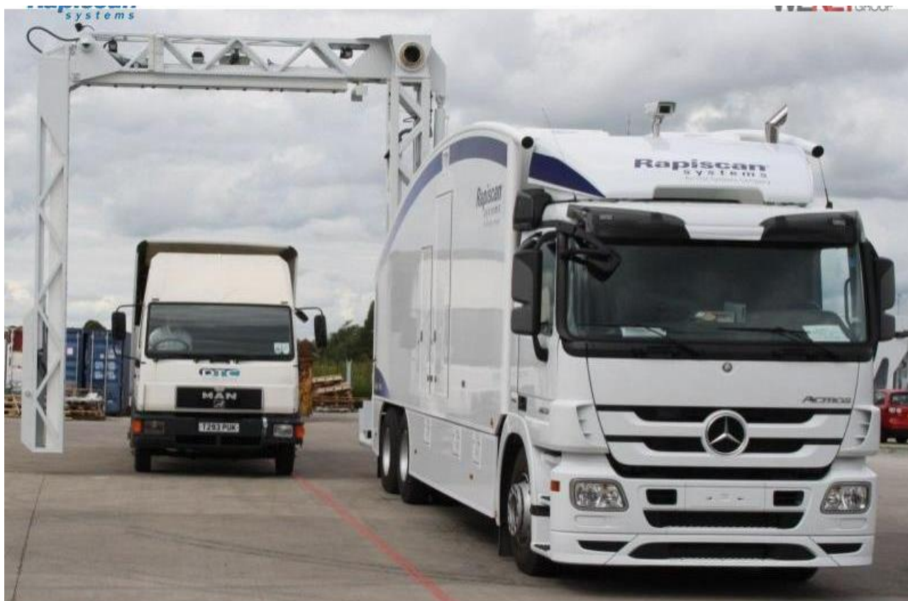
Рис. 2.30. Мобильный инспекционно-досмотровый комплекс Eagle M45
