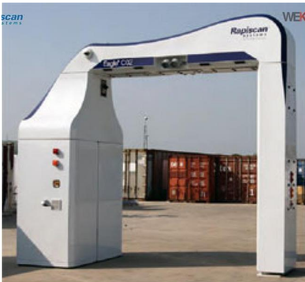
Рис. 2.31. Инспекционно-досмотровый комплекс Eagle CO2
