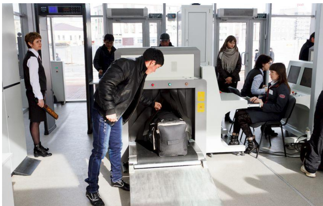
Рис. 2.14. Минимальная комплектация поста досмотра пассажира и его ручной клади при входе на объект транспортной инфраструктуры
