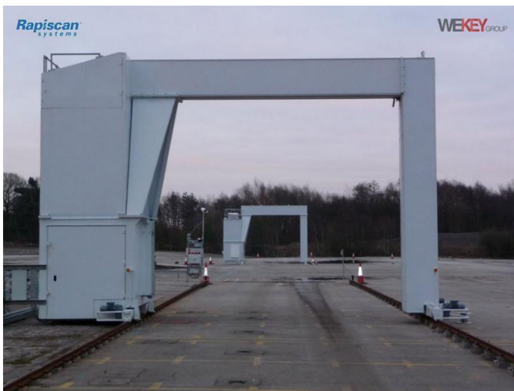
Рис. 2.33. Портальный инспекционно-досмотровый комплекс Eagle P45
