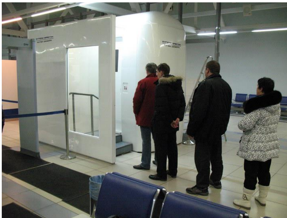
Рис. 2.10. Система рентгенографического контроля «СибСкан» в аэропорту «Толмачево» г. Новосибирск
