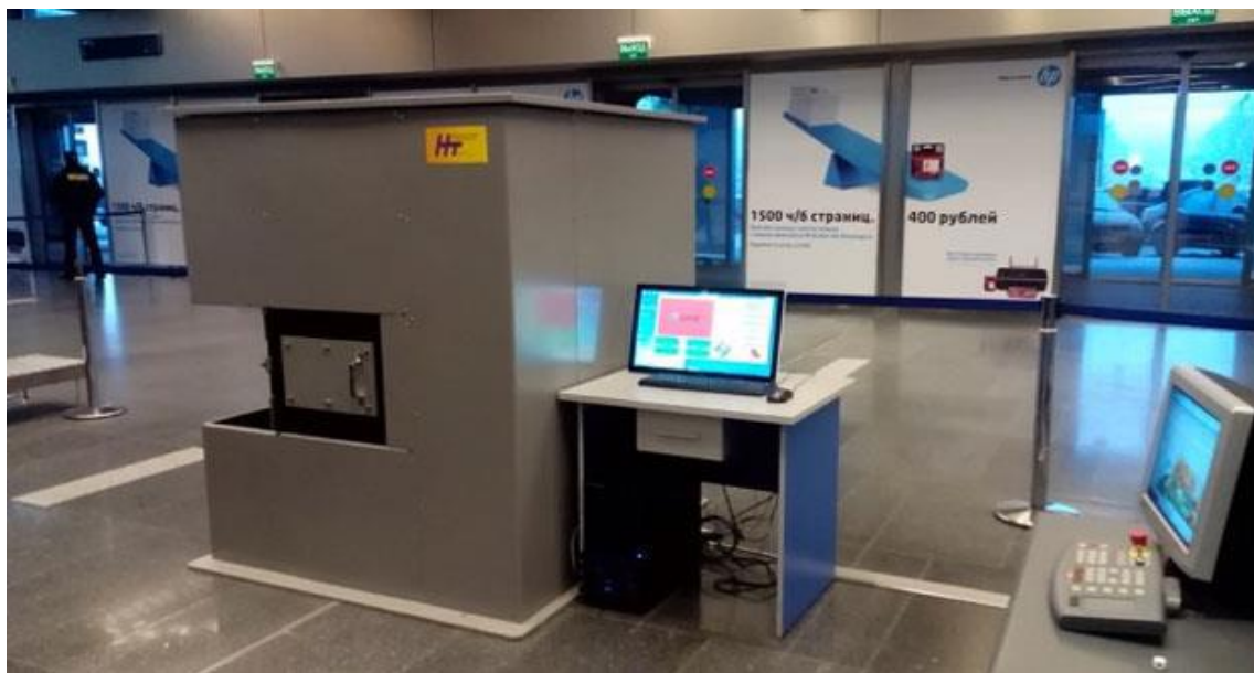
Рис. 2.23. Аппаратура обнаружения жидких взрывчатых и горючих веществ – Широта-ЖВВ
