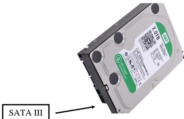
*Рис. 49. Магнитный жесткий диск Western Digital WD20EZRX*
