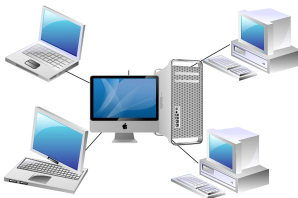
*Рис. 72. Сетевая топология типа звезда*
