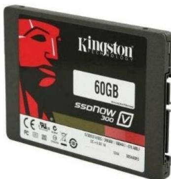
*Рис. 50. Твердотельный накопитель SSD Kingston SV300S37A/60G*
