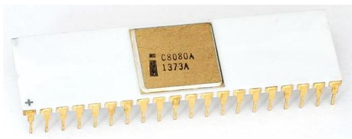
*Рис. 34. Микропроцессор Intel 8080*
