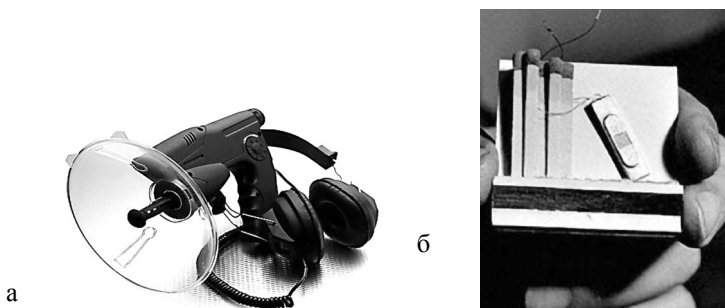
Рис. 3.6. Устройства перехвата информации по акустическому каналу: а) направленный микрофон; б) радиозакладка, закамуфлированная под коробок спичек
