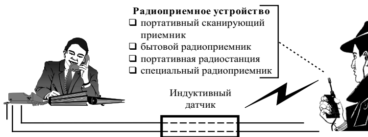
Рис. 3.4. Схема бесконтактного перехвата информации, передающейся по телефонной линии
