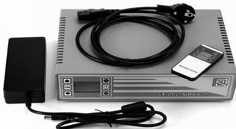
Рис. 3.15. Блокиратор сотовой и беспроводной связи ST 202 «UDAV-M»
