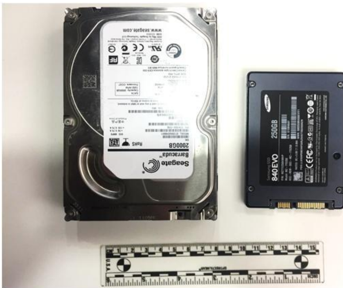
Рис. 5. Внешний вид НЖМД (HDD) – слева, и твердотельного накопителя (SSD) – справа
