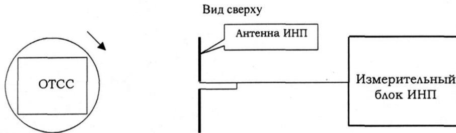
Рис. 3.18. Схема размещения измерительной аппаратуры и источника электромагнитного излучения
