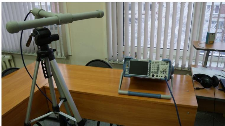
Рис. 3.17. Программно-аппаратный комплекс проведения специальных исследований «Легенда-05М»
