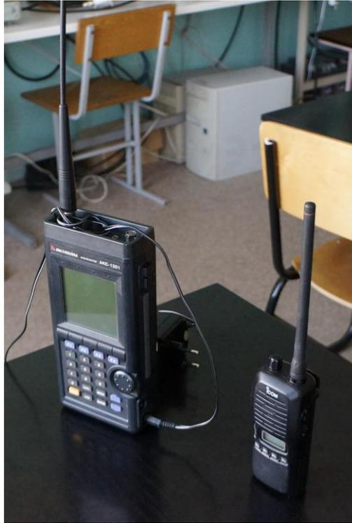
Рис. 3.13. Анализатор электромагнитного поля АКС-1201
