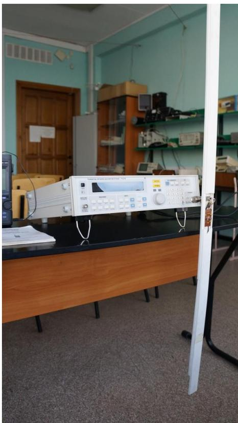
Рис. 3.12. Генератор сигналов высокочастотный Г4-218
