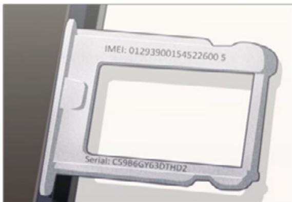
Рис. 7. IMEI, нанесенный на держателе SIM-карты сотового телефона
