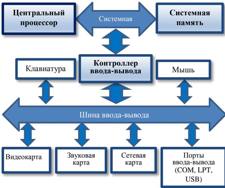
Рис. 2.1.6. Шинная архитектура персонального компьютера
