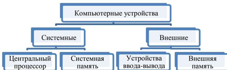
Рис. 2.1.3. Классификация компьютерных устройств
