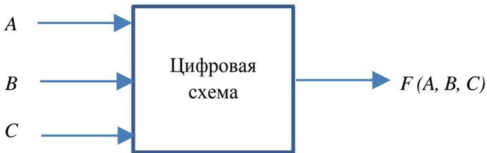
Рис. 1.4.1. Функция преобразования логических переменных
