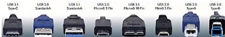
*Рис. 2.1.15. Типы USB-разъемов*
