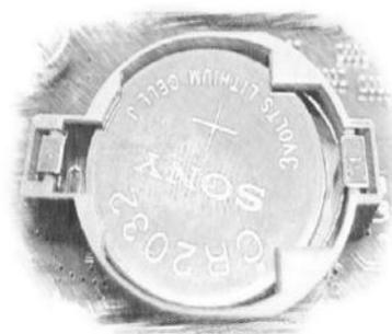
Рис. 7.5. Элемент питания CMOS
