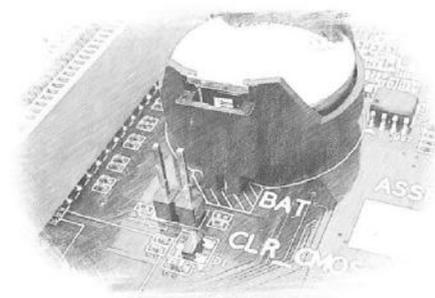
Рис. 7.6. Перемычка для сброса CLR CMOS
