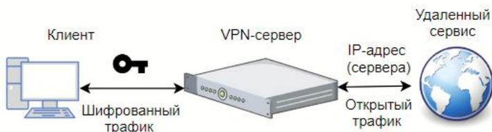
Рис. 3.3. Общий принцип работы туннелирования
