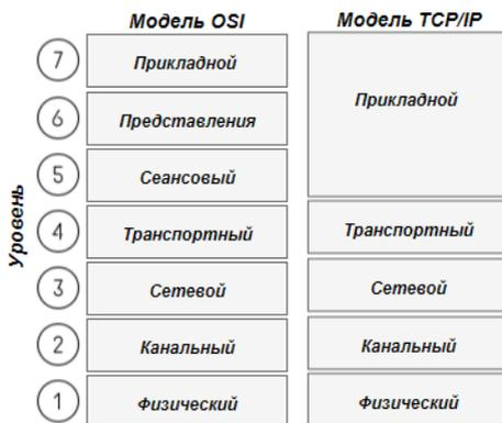
Рис. 9.3. Сокращенный вариант модели OSI
