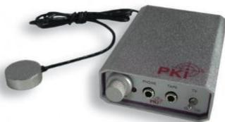
Рис. 1.12. Электронный стетоскоп РКИ-2850
