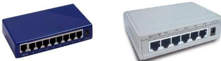
Рис. 10.1. Сетевые концентраторы
