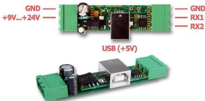
Рис. 1.16. Serial Logger AirDrive Pro
