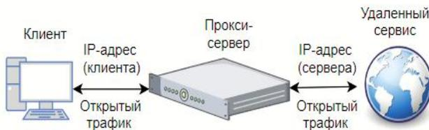
Рис. 3.2. Принцип работы прокси-сервера
