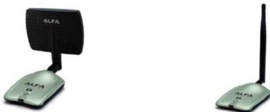
Рис. 1.24. Беспроводной USB-адаптер AWUS036NH
