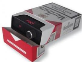
Рис. 1.10. Направленный микрофон внутри сигаретной коробки
