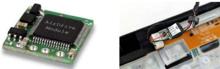
Рис. 1.17. Модуль кейлоггера AirDrive Forensic Keylogger Module Pro
