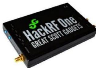
Рис. 1.9. Программно определяемая радиосистема HackRF
