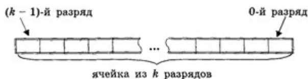
Рис. 2. Схема регистра и ячейки памяти
