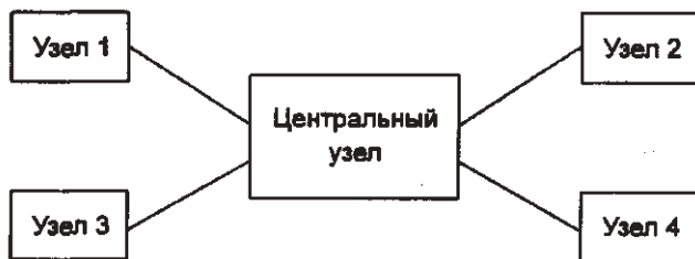
Рис. 58. Сеть звездообразной топологии
