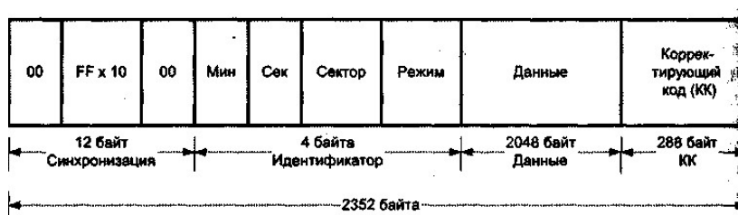
Рис. 20. Формат блока CD-ROM
