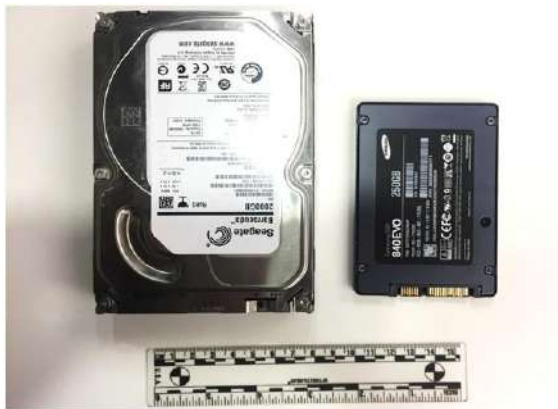
Рис. 5. Внешний вид НЖМД (HDD) – слева, вид твердотельного накопителя (SSD) – справа
