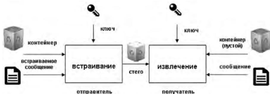
Рис. 1. Схема стенографической передачи данных
