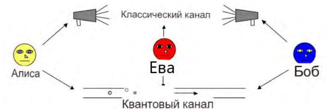
Рис. 1. Базовая модель квантового распределения ключей
