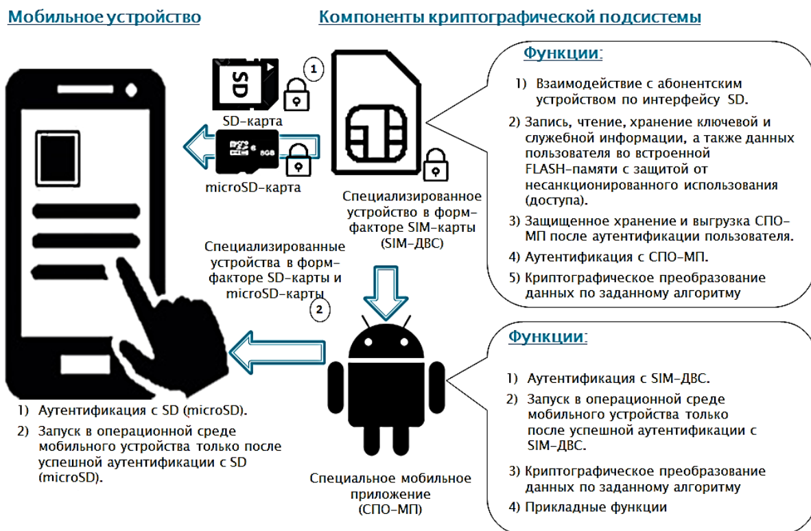
Рис. 2.6. Принцип встраивания криптографической подсистемы в мобильное устройство
