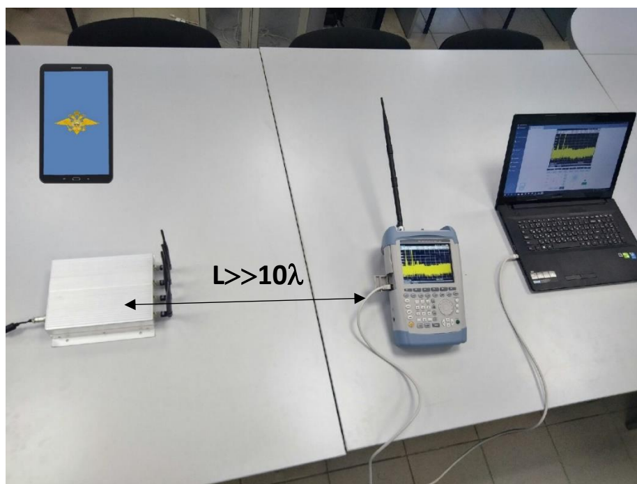
Рис. 1.2. Фото экспериментальной установки. В качестве источника ДЭМВ используется «Alligator-40»
