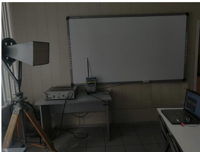
Рис. 1.5. Фото экспериментальной установки по воспроизведению ДЭМВ. В качестве источника ДЭМВ используется Г4-83
