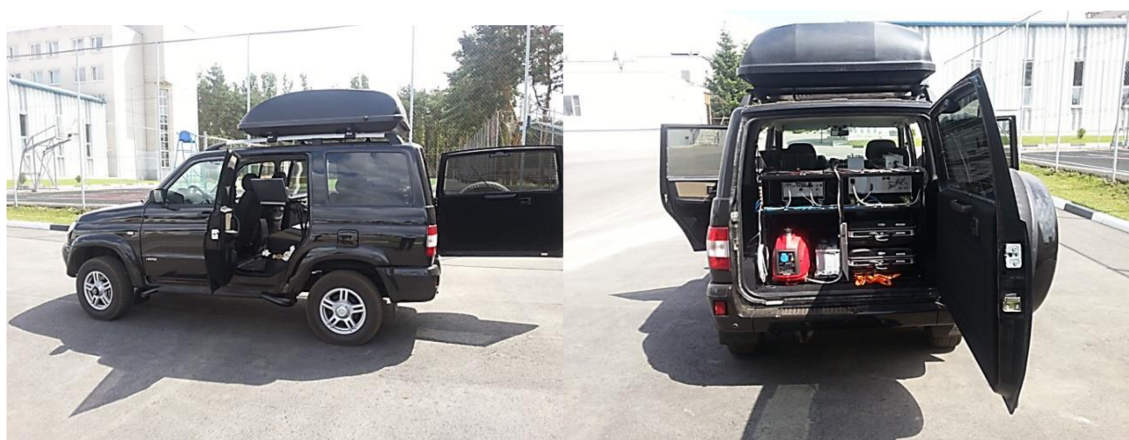
Рис. 2.21. Комплекс пеленгования источников радиоизлучений «Барс-МПИ2» на базе автомобиля УАЗ Патриот, развернутый в Воронежском институте МВД России на кафедре инфокоммуникационных систем и технологий
