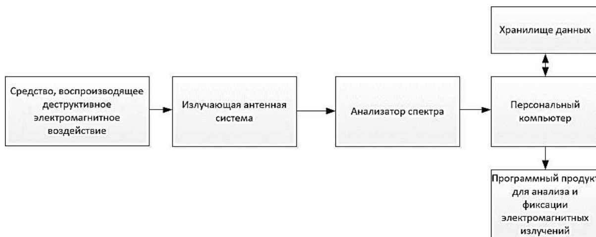
Рис. 1.10. Типовая схема проведения экспериментальных исследований при помощи лабораторных средств
