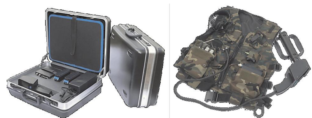
Рис. 2.22. Носимый комплекс поиска, обнаружения и пеленгования источников радиоизлучений «Барс-Н»
