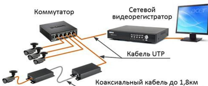
Рис. 6. Схема удаленного подключения (до 1,8 км) одной IP видеокамеры к сетевому видеорегистратору по коаксиальному кабелю
