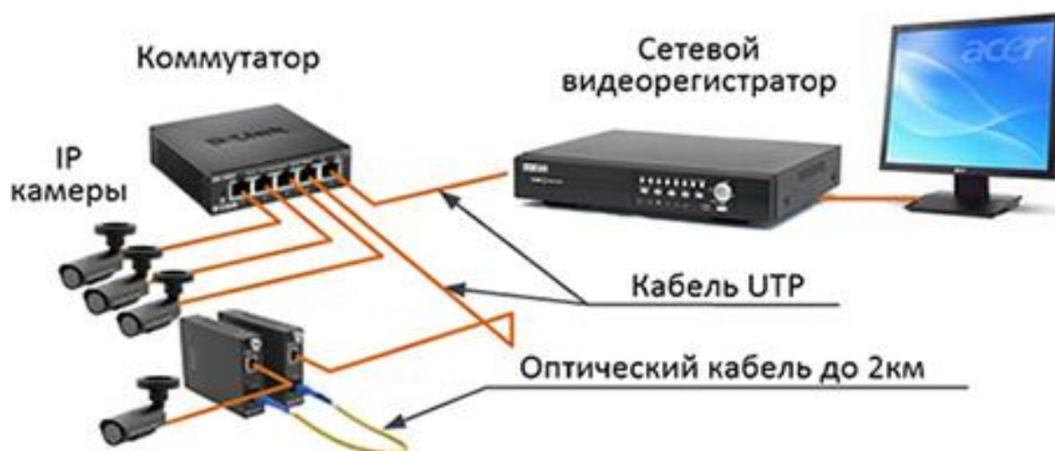
Рис. 4. Схема удаленного (до 2 км) подключения одной IP камеры к сетевому видеорегистратору по оптоволоконному кабелю.
