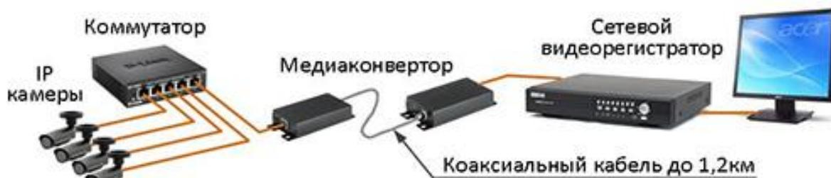
Рис. 5. Схема удаленного (до 1,2 км) подключения 4-х IP камер к сетевому видеорегистратору по коаксиальному кабелю
