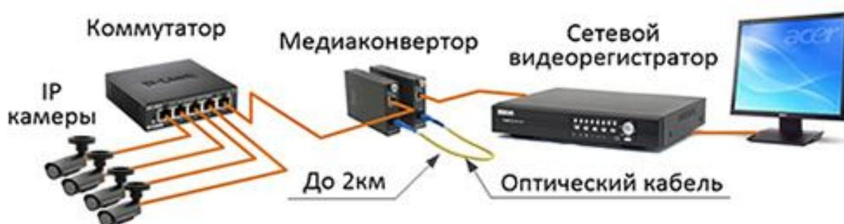
Рис. 3. Схема удаленного (до 2 км) подключения 4-х IP камер к сетевому видеорегистратору по оптоволоконному кабелю.
