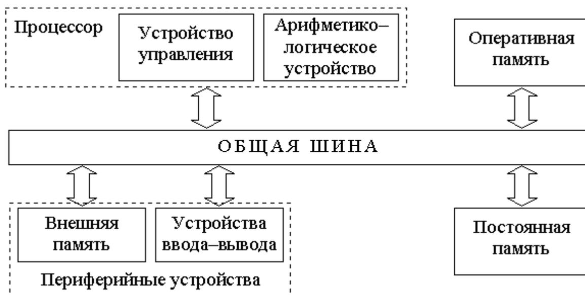
Рисунок 2.3. Структурная схема ЭВМ
