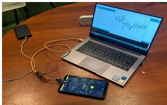
Рис. 3. Результаты передачи звукового сигнала через микрофон модели АР, отображаемые на компьютере
