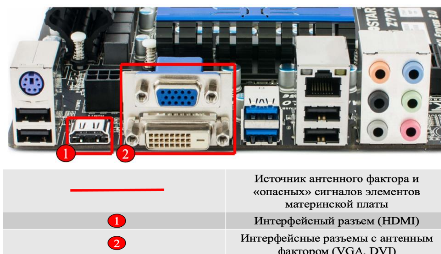
Рис. 3. Источник «опасных» информативных сигналов интерфейсных разъемов материнской платы по видеотракту
