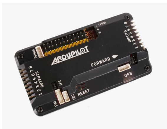
Рис. 1. Специализированные контроллеры на базе «ArduPilot»
