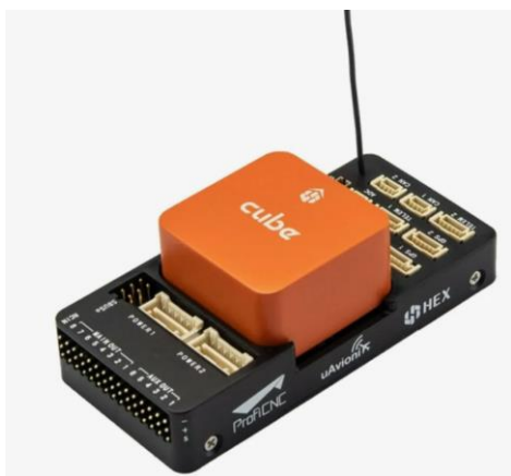
Рис. 1. Специализированные контроллеры на базе «ArduPilot»
