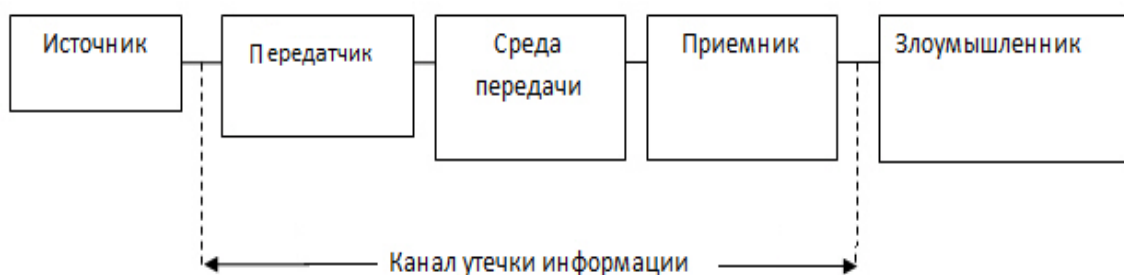
Рис. 5. Структура технического канала утечки информации
