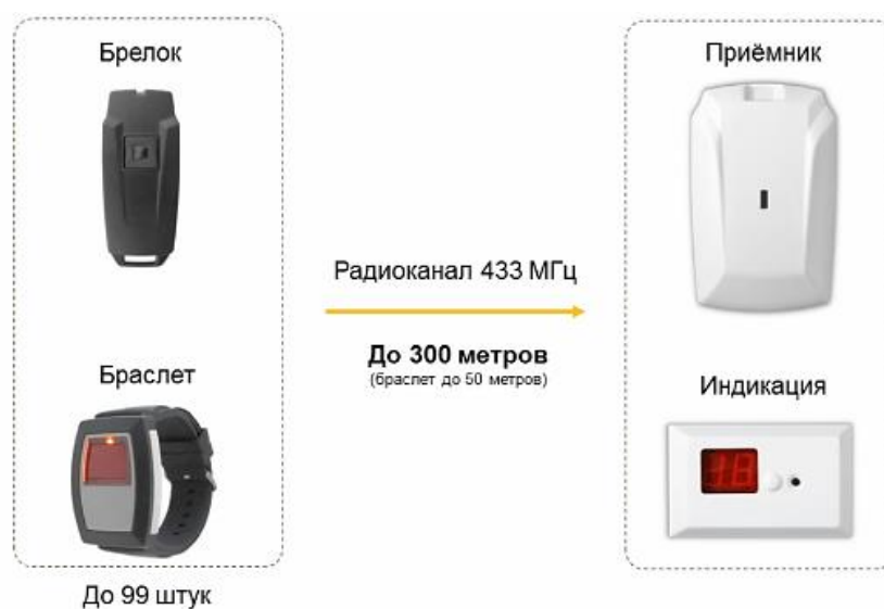
Рис. 4. Схема работы системы «Астра-Р»
