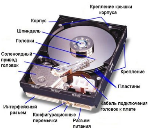
Рисунок 1.9. Устройство НЖМД
