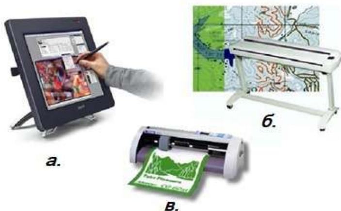
Рис. 2.12. Системы вывода информации ГИС-карт: а – дисплей; б – плоттер; в – принтер
