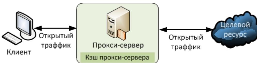
Рис. 20. Схема работы прокси-сервера
