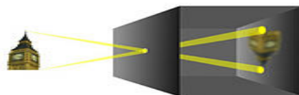
Рис. 2. Схема работы камеры-обскура
