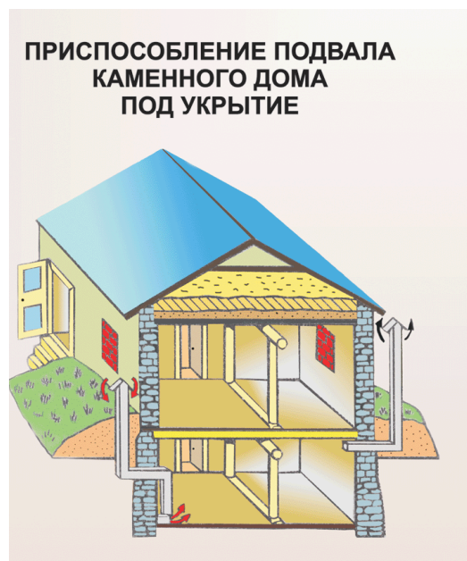
Рис. 12. Оборудование подвального помещения под противорадиационное укрытие
