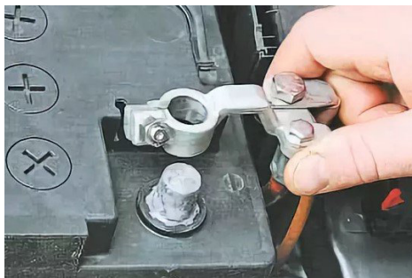
Рис. 58. Отсоединение провода от аккумулятора
