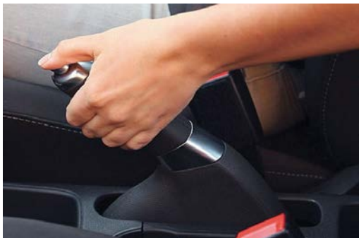
Рис. 23. Включение стояночного тормоза
