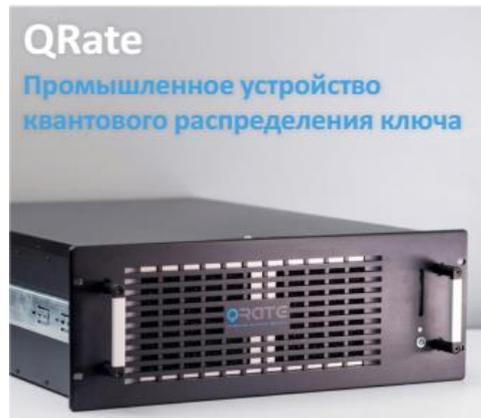
Рис. 8. Квантовые коммуникации компании «QRATE» (содержит передатчик с генератором фотонов и приемник)
