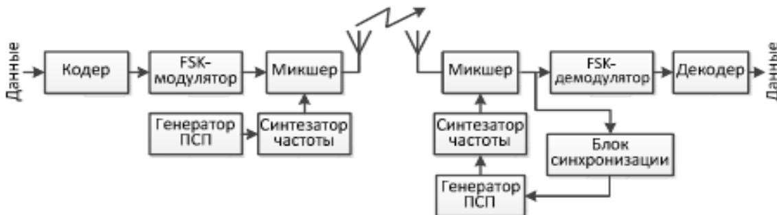
Рис. 1. Упрощенная структурная схема системы связи с ППРЧ
