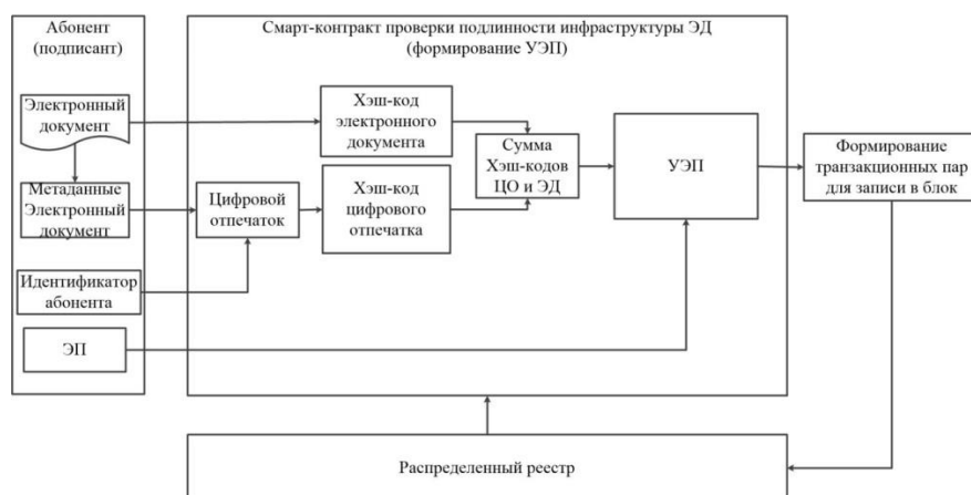
Рис. 2. Подписание созданного ЭД. Автоматическое формирование регистрирующей записи в распределенном реестре
