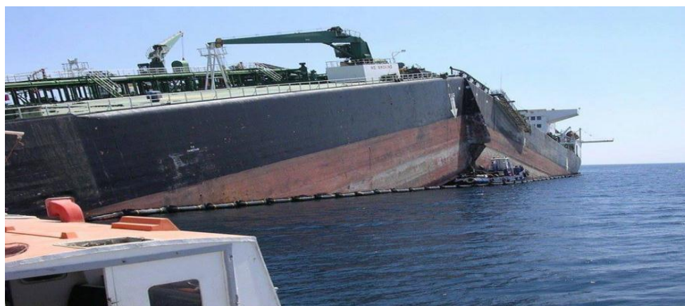
Рисунок 2 – Разрушение в результате усталости металла корпуса судна
