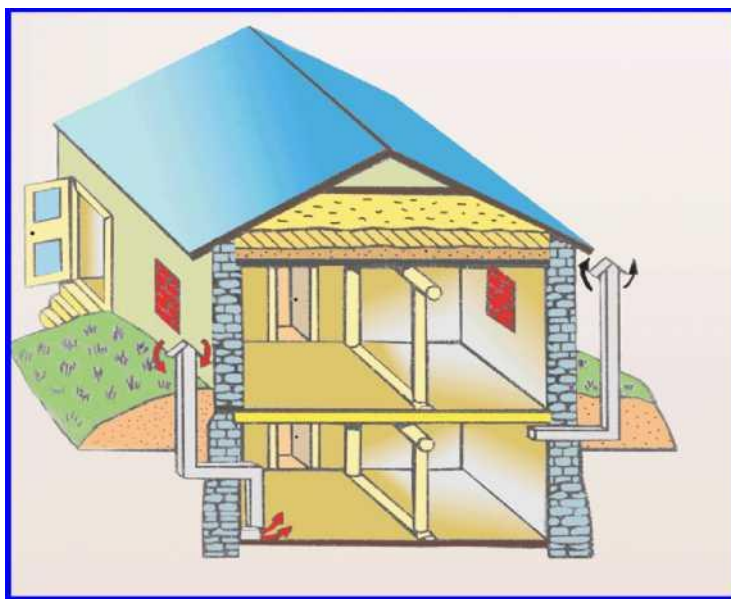
Рис. 15. Оборудование подвального помещения под противорадиационное укрытие
