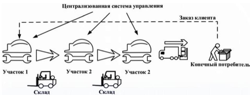
Рис. 4.14. Схема «толкающей» системы
