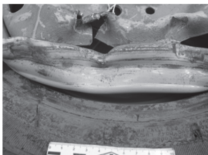
Рис. 2. Сочетание повреждений в виде загиба, разрыва и трех вмятин на закраине диска колеса
