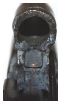
Рис. 4. Следы установки самодельного ствола в конструкцию пистолета списанного охолощенного Baikal-P411
