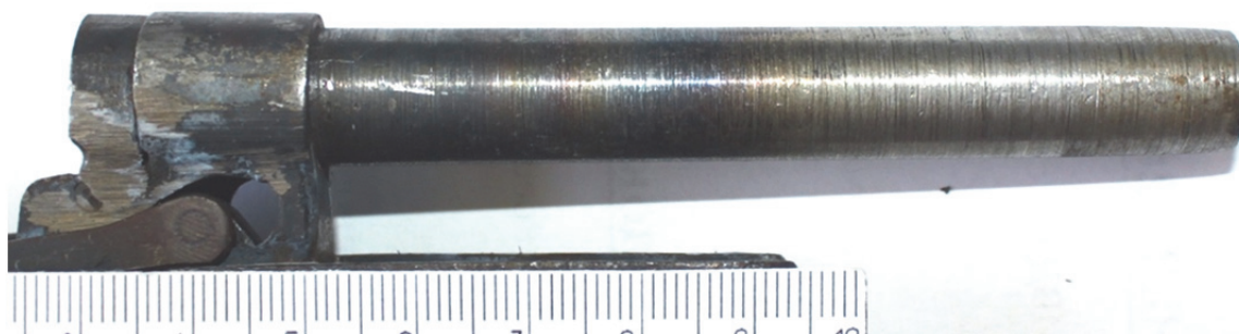
Рис. 2. Самодельно-изготовленный ствол, установленный в конструкцию пистолета списанного охолощенного Baikal-P411
