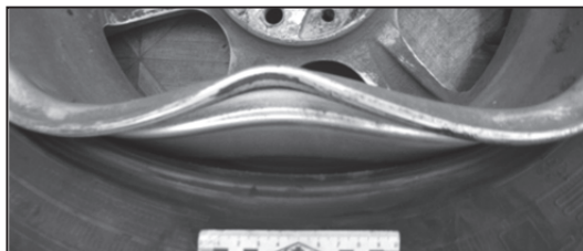
Рис. 1. Повреждение в виде загиба закраины диска колеса
