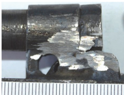
Рис. 3. Следы установки самодельного ствола в конструкцию пистолета списанного охолощенного Baikal-P411
