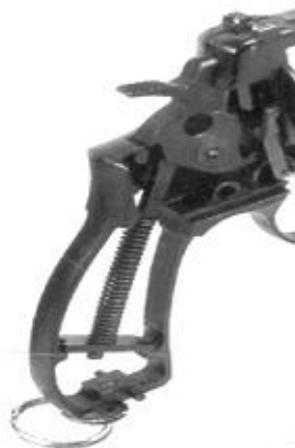
Рис. 62. Боевая пружина витая
