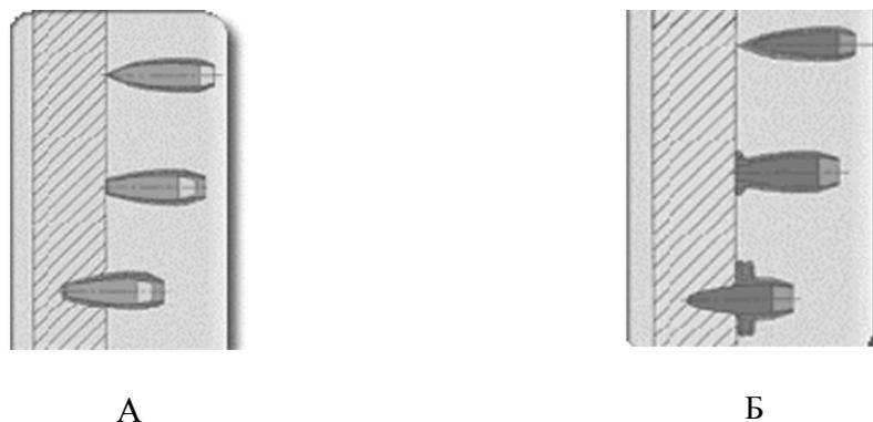
Рис. 147. Схема проникновения в преграду: А – пули патрона 7Н10; Б – пули модернизированного патрона 7Н10М
