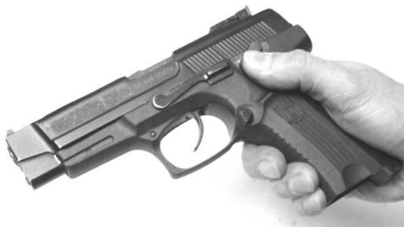
Рис. 42. Постановка пистолета на предохранитель
