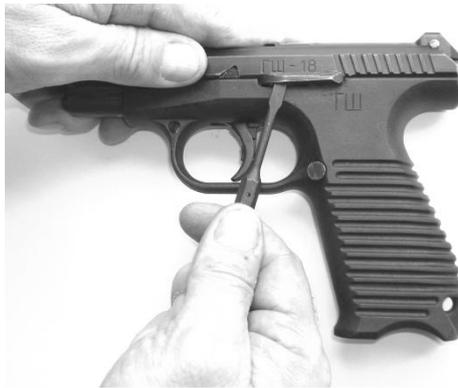
Рис. 26. Неполная разборка: извлечь затворную задержку
