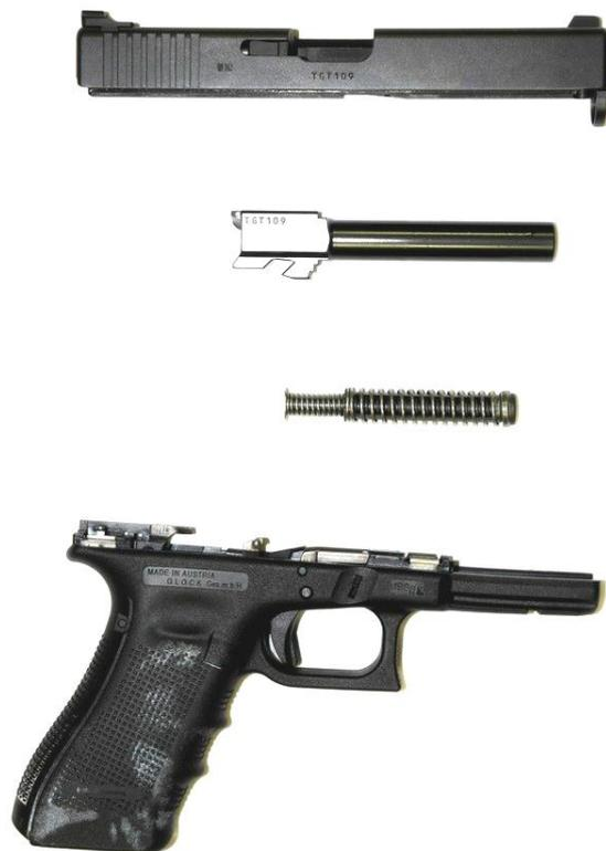
Рис. 53. Пистолет «Глок-17» после неполной разборки: рукоятка, затвор, ствол и возвратно-боевая пружина с направляющим стержнем, магазин
