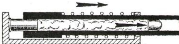
Рис. 14. Схема запирания с помощью движущегося вперед ствола
