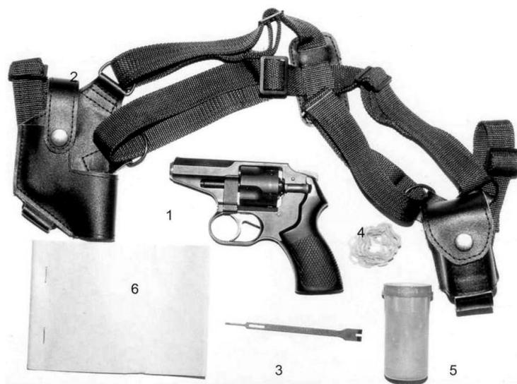
Рис. 75. Комплект Р-92: 1 – револьвер Р-92; 2 – кобура для скрытого ношения; 3 – протирка; 4 – обоймы; 5 – масленка; 6 – инструкция по эксплуатации
