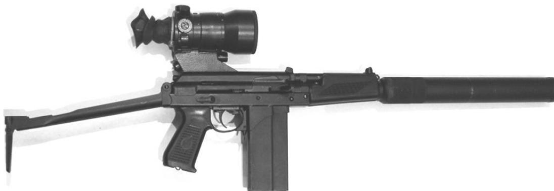
Рис. 115. 9-мм малогабаритный автомат 9А-91 с ночным прицелом и глушителем
