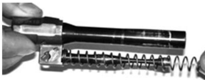
Рис. 9. Расположение возвратной пружины под стволом в пистолетах 6П35 – Пистолет Ярыгина, МР-446 «Викинг»
