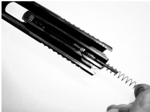
Рис. 28. Неполная разборка: извлечь боек с боевой пружиной и втулкой
