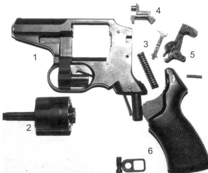
Рис. 76. Р-92 после неполной разборки:
