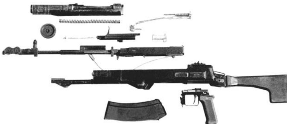
Рис. 110. Общее устройство 5,45-мм автомата Никонова AN-94
