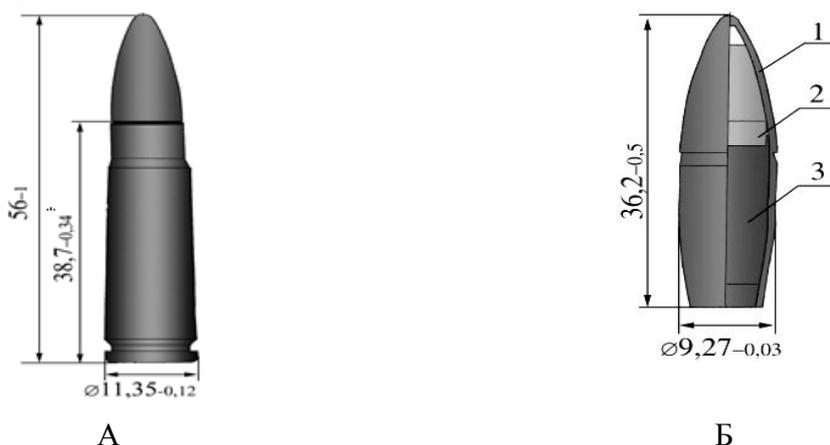
Рис. 163. 9-мм снайперский патрон: А – патрон; Б – пуля: 1 – оболочка; 2 – сердечник стальной; 3 – сердечник свинцовый
