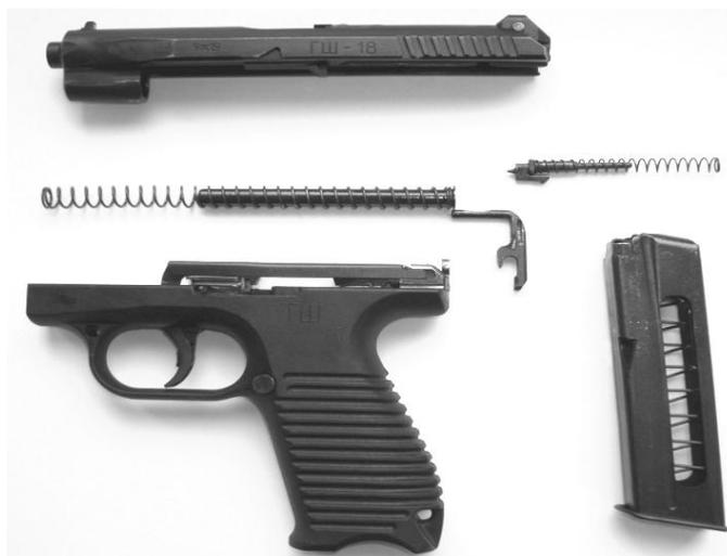
Рис. 30. Пистолет ГШ-18 после неполной разборки
