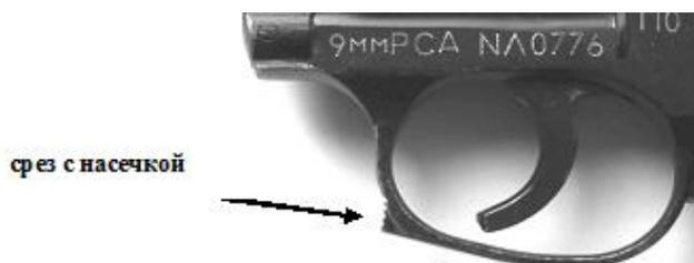
Рис. 56. Специальный срез на передней стенке скобы
