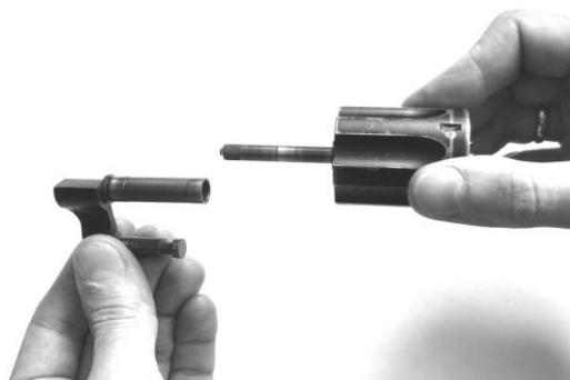
Рис. 72. Неполная разборка: снять барабан с качалки
