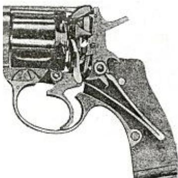
Рис. 61. Боевая пружина пластинчатая
