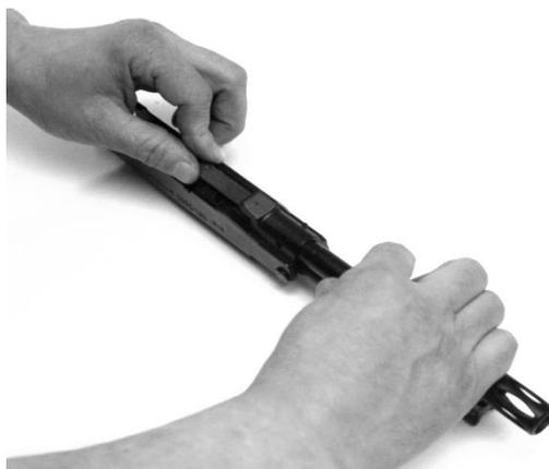
Рис. 100. Установка затвора в ствольную коробку
