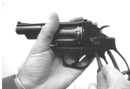
Рис. 70. Неполная разборка: вывернуть винт щеки и отделить щеку
