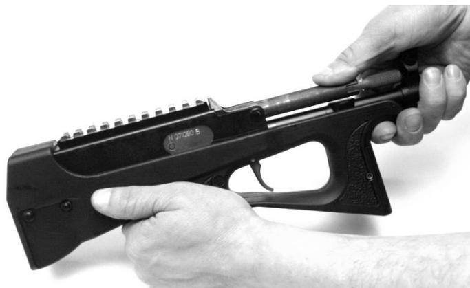
Рис. 103. Фиксация ствольной коробки на рукоятке
