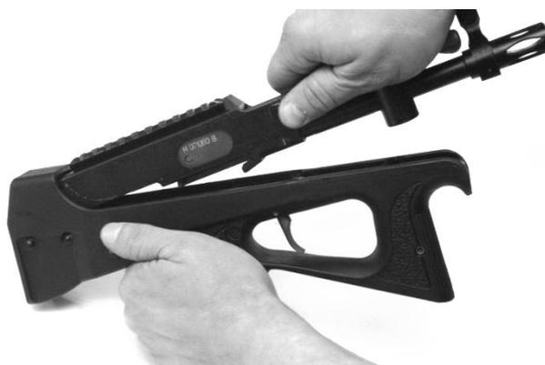
Рис. 101. Введение выступающей части штока внутрь рукоятки
