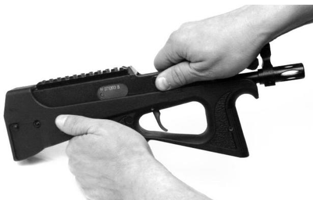
Рис. 102. Продвижение ствольной коробки в рукоятку
