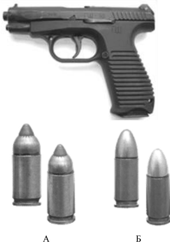
Рис. 23. Общий вид пистолета ГШ-18; патроны: А – 9x19-мм ПБП с бронебойной пулей (патрон 7Н31), Б – 9x19-мм «Парабеллум»
