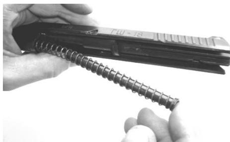
Рис. 29. Неполная разборка: извлечь шток с возвратной пружиной
