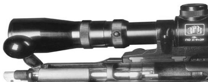
Рис. 124. Затвор и оптический прицел ПКС-07-У снайперской винтовки МЦ-116М
