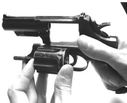
Рис. 71. Неполная разборка: отсоединить качалку с барабаном
