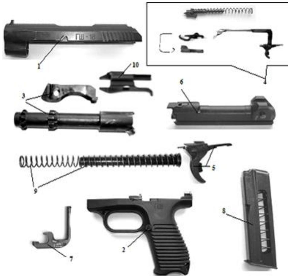
Рис. 24. Основные части и механизмы пистолета ГШ – 18: 1– кожух-затвор; 2 – рукоятка; 3 – ствол, фиксатор ствола; 4 – ударно-спусковой механизм: спусковой крючок, боек с втулкой, боевая пружина, разобщитель, шептало с пружиной; 5 – предохранитель; 6 – остов затвора с выбрасывателем и ограничителем; 7– затворная задержка; 8 – магазин; 9 – шток с возвратной пружиной; 10 – отражатель
