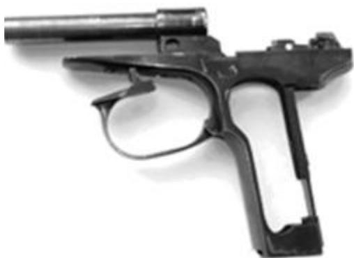
Рис. 7. Рамка с отделяемой спусковой скобой
