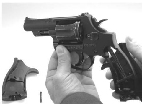
Рис. 69. Неполная разборка: отделить накладки
