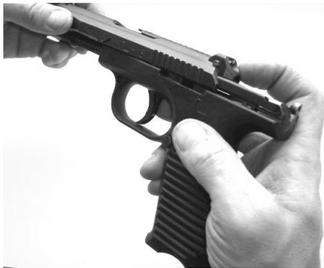
Рис. 27. Неполная разборка: сдвинуть затвор вперед и отделить от рукоятки
