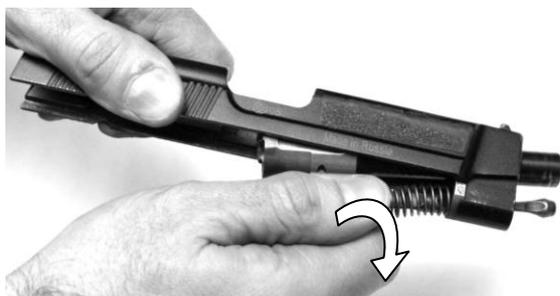
Рис. 36. Отсоединение ствола со штоком и возвратной пружиной от затвора
