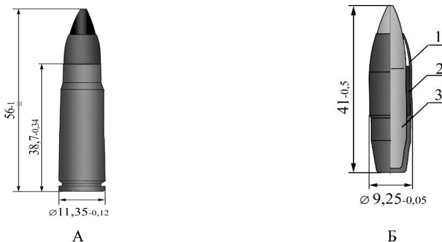
Рис. 164. 9-мм патрон с бронебойной пулей: А – патрон; Б – пуля: 1 – оболочка; 2 – рубашка; 3 – сердечник стальной
