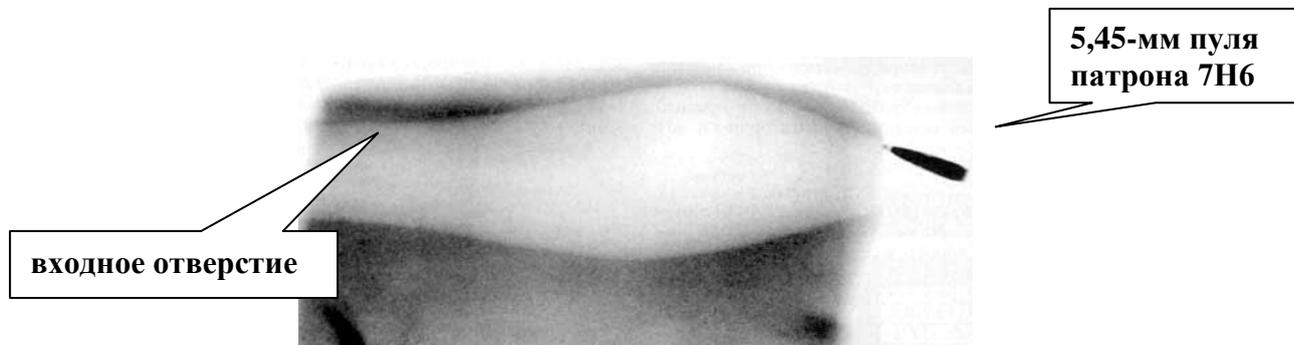
Рис. 174. Импульсная рентгенограмма. Опрокидывание 5,45-мм пули патрона 7Н6 в желатиновом блоке. Деформация пули отсутствует (дальность стрельбы – 10 м, входное отверстие слева)
