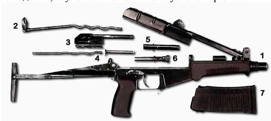
**Рисунок 2.28. Общее устройство автомата СРЗ:**
