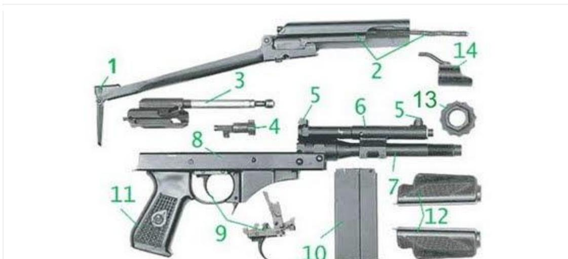
**Рисунок 2.24. Основные части и механизмы автомата 9А-91**
