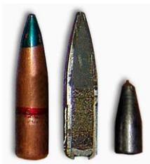
Модернизация позволила увеличить дальность трассирования до 850 м и обеспечила задержку воспламенения трассирующего состава на 50-120 м от дульного среза (см. рис. 4.8). Головная часть пуль всех трассирующих патронов окрашена в зеленый цвет.
