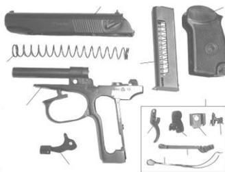
1. Рамка со стволом и спусковой скобой. (Предназначена для соединения всех частей и механизмов пистолета, спусковая скоба – для предотвращения от случайного нажатия на хвост спускового крючка, ствол – для направления полета пули, нарезы – для придания пуле вращательного движения).
