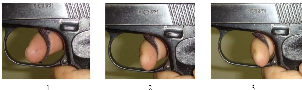
Рис. 7. Фазы обработки спуска
