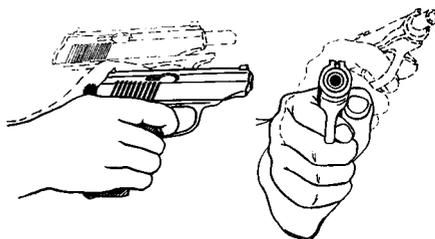
Рис. 22. Движение пистолета при отдаче а — вид сбоку; б — вид спереди
