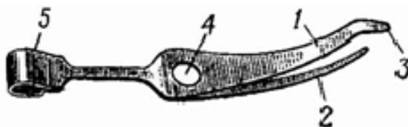
Рис. 23. Боевая пружина: 1 - широкое перо; 2 - узкое перо; 3 -отбойный конец; 4 - отверстие; 5 – защелка
