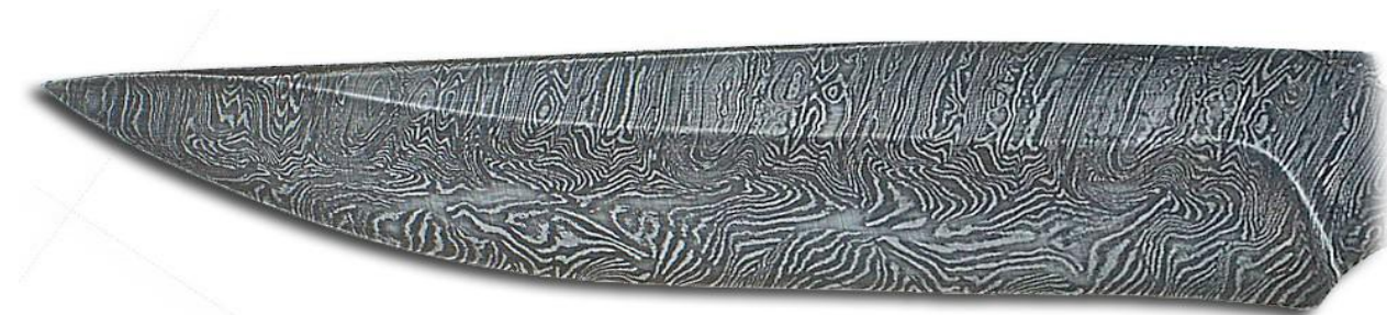
Рис. 3. Клинок из дамасской стали
