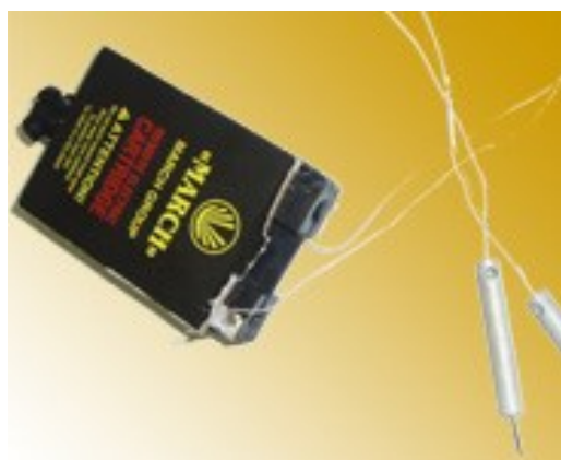
Рис. 76. Внешний вид токопроводящих проводов и электродов стреляющего картриджа «БТЭР»: а) сработавший картридж «БТЭР» с выпущенными гарпунами; б) внешний вид гарпунов картриджа «БТЭР».
