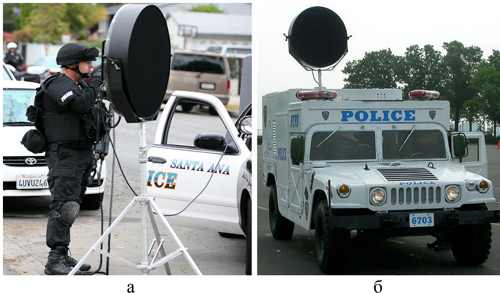
Рис. 129. Инфразвуковое (акустическое) оружие LRAD в полиции: а) носимый вариант LRAD; б) мобильный вариант LRAD.
