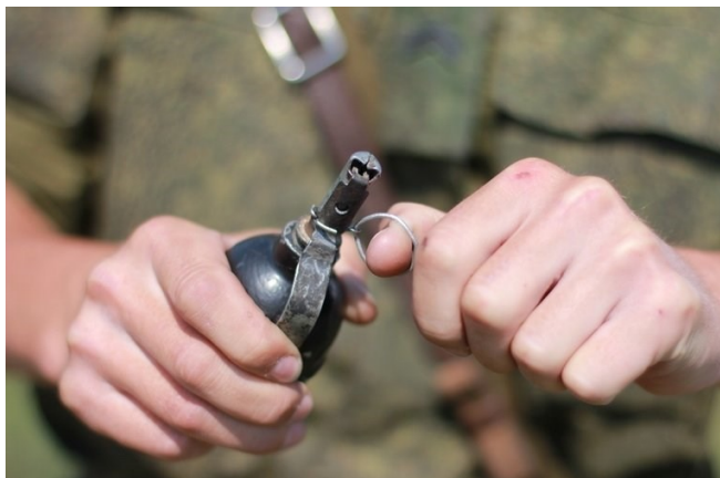
Рис. 100. Подготовка ручной светозвуковой гранаты «Заря-2» к броску.
