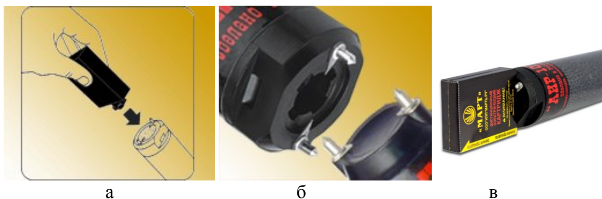
Рис. 74. Установка картриджа на АИР-107У: а) направление установки картриджа на ЭШУ; б) совмещение электродов картриджа и ЭШУ; в) внешний вид установленного картриджа на ЭШУ.
