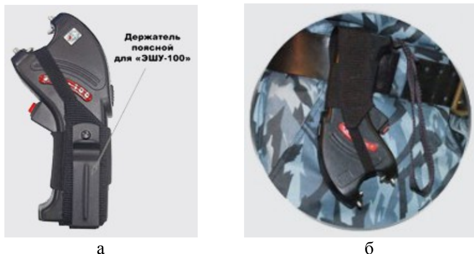
Рис. 67. Способ ношения «ЭШУ-100»: а) расположение держателя поясного на «ЭШУ-100»; б) размещение «ЭШУ-100» на поясе сотрудника.
