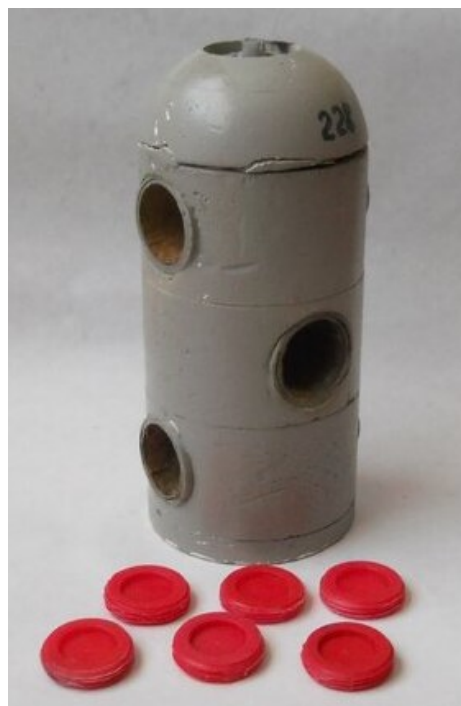
Рис. 91. Корпус и заглушки сработавшей ручной светозвуковой гранаты «Факел».
