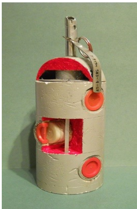
Рис. 90. Внутреннее расположение светозвуковых элементов в ручной светозвуковой гранате «Факел».
