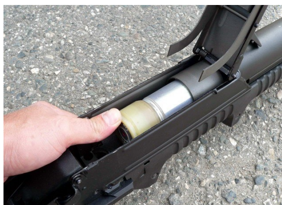
Рис. 15. Снаряжение выстрелом гранатомёта ГП-94.
