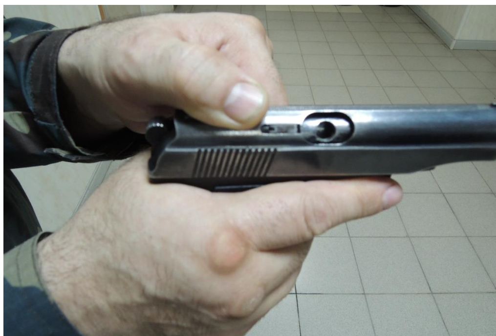
Фото 36. Включение предохранителя. Вид справа
