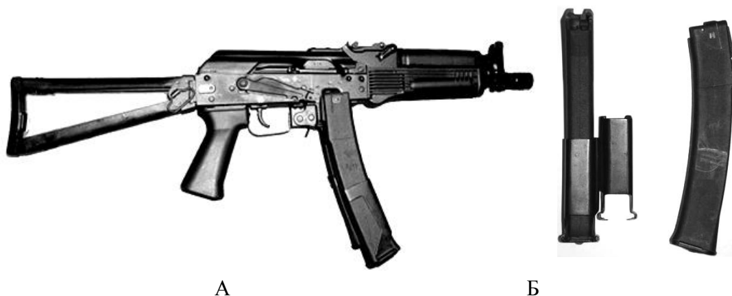
Рис.14. А - 9-мм пистолет-пулемет ПП-19-01 «Витязь», Б – специальная скоба для попарного скрепления магазинов
