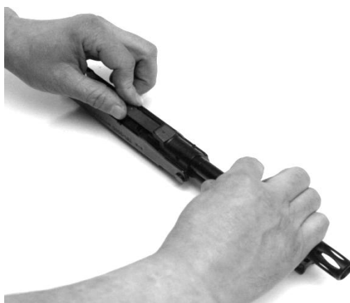
Рис. 24. Установка затвора в ствольную коробку
