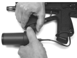
Рис. 20. Извлечение кронштейна с фонарем
