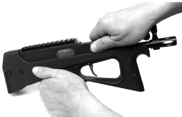
Рис. 26. Продвижение ствольной коробки в рукоятку
