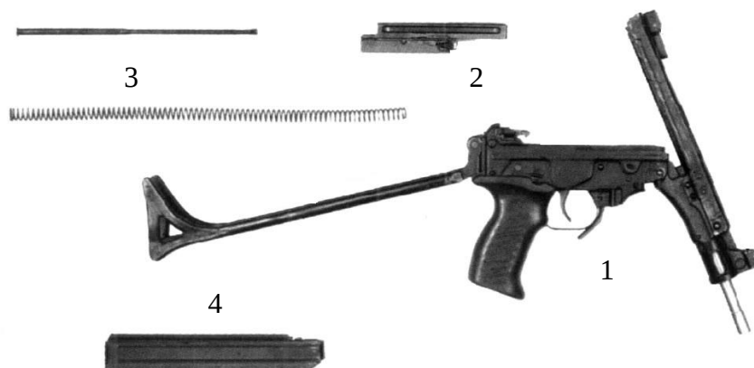
Рис. 11 Пистолет-пулемет ОЦ-02 «Кипарис» после неполной разборки:
