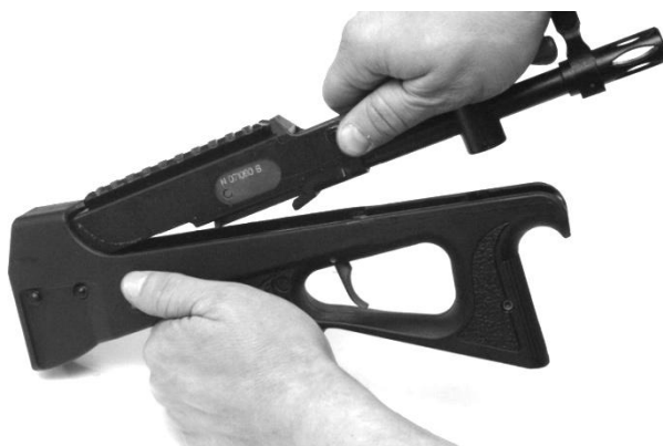
Рис. 25. Введение выступающей части штока внутрь рукоятки
