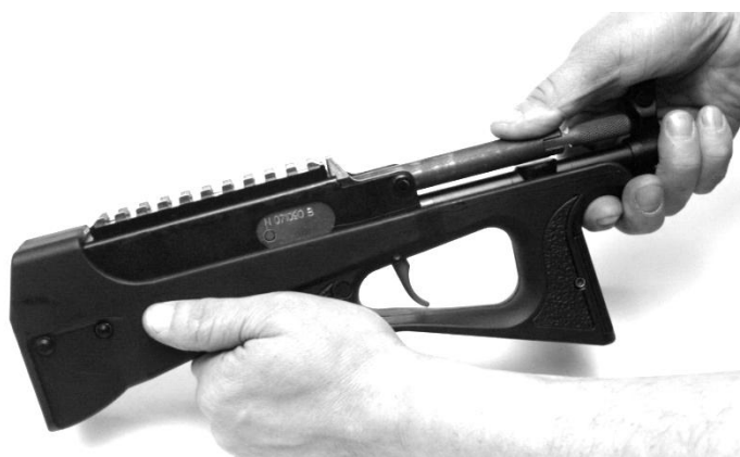
Рис. 27. Фиксация ствольной коробки на рукоятке
