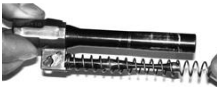
Рис. 3. Расположение возвратной пружины под стволом в пистолетах 6П35 – Пистолет Ярыгина, МР – 446 «Викинг»
