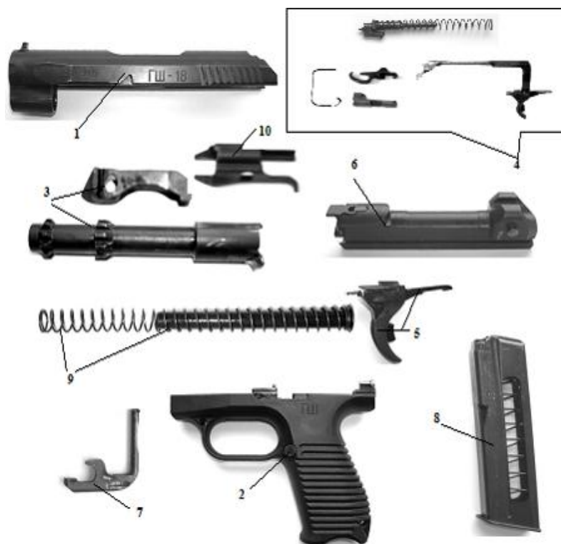
Рис. 18. Основные части и механизмы пистолета ГШ – 18: 1- кожух - затвор; 2 - рукоятка; 3 - ствол, фиксатор ствола; 4 - ударно - спусковой механизм: спусковой крючок, боек с втулкой, боевая пружина, разобщитель, шептало с пружиной; 5 - предохранитель; 6 - остов затвора с выбрасывателем и ограничителем; 7- затворная задержка; 8 - магазин; 9 - шток с возвратной пружиной; 10 - отражатель
