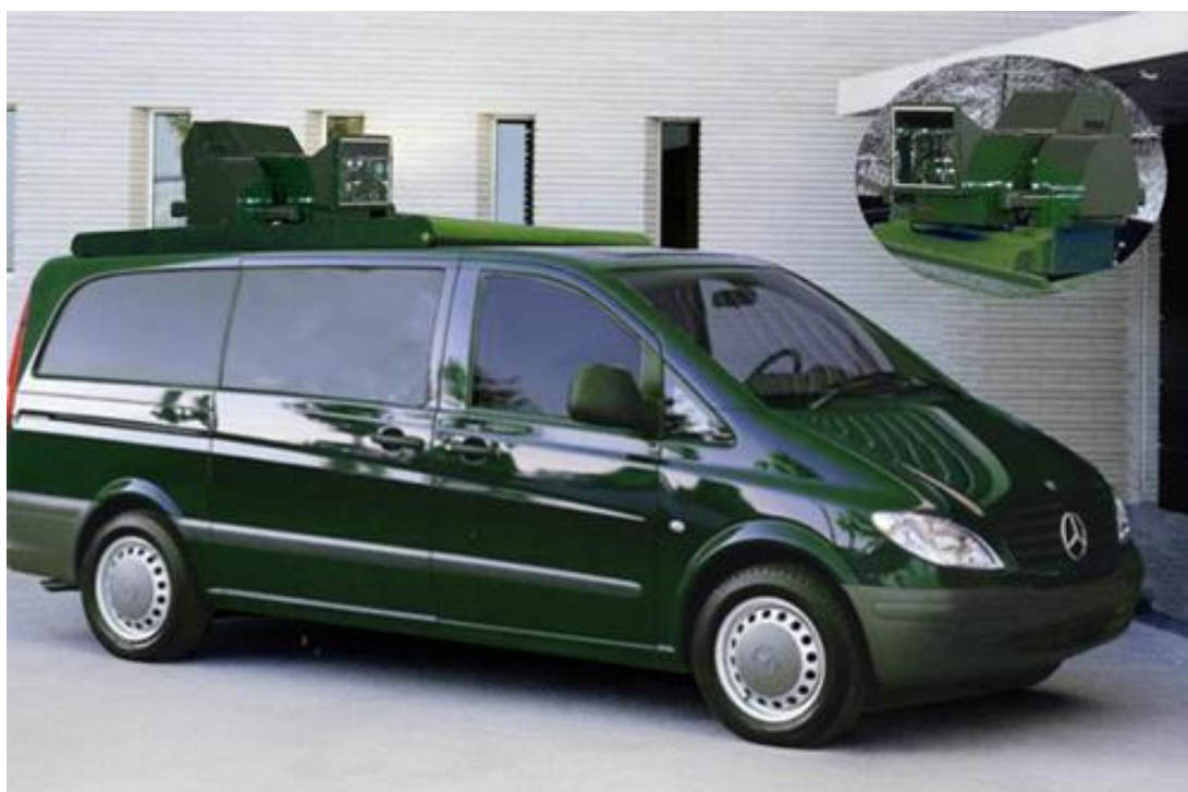
Рис. 26. Мобильная станция подавления снайперов «МЛС-101»
