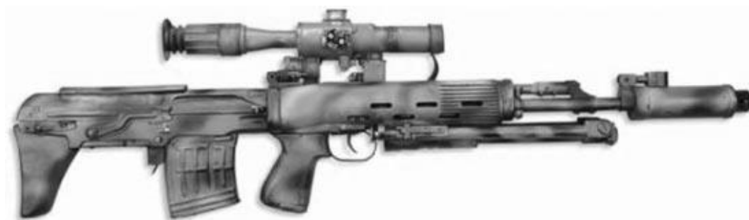
Рис. 8. Общий вид 7,62-мм СВУ-АС с оптическим прицелом ПСО-1, сошки сложены
