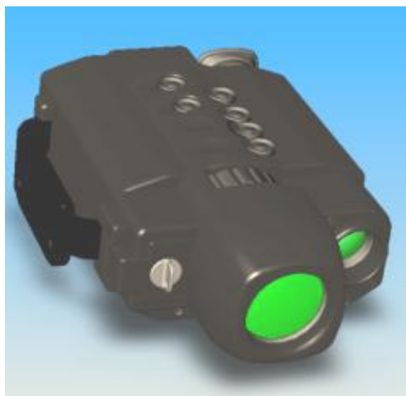
Рис. 28. Прибор обнаружения оптических устройств «Призрак-М» («ТЛС 2000»)
