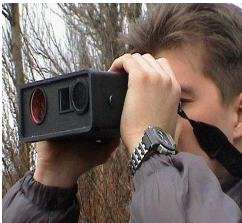
Рис. 27. Прибор выявления оптических приборов «ЛАР-1Е»
