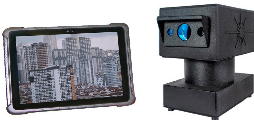
Рис. 31. Сканирующий обнаружитель средств наблюдения «Сосна»
