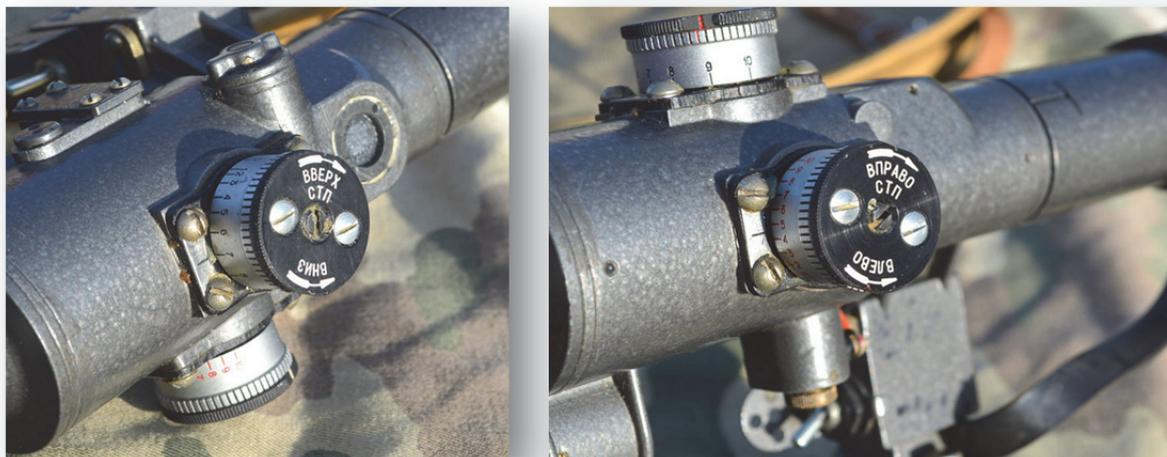
Соединительный винт связывает торцовую гайку с кареткой и при вращении маховичка или гайки передвигает каретку с сеткой прицела в нужном направлении.
