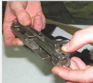
7. Отделить ударно - спусковой механизм. Повернуть предохранитель вверх до вертикального положения, сдвинуть его вправо и отделить от ствольной коробки, взявшись за спусковую скобу, движением вниз отделить ударно - спусковой механизм от ствольной коробки.
