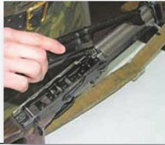
5. Отделить затворную раму с затвором. Отвести затворную раму назад до отказа, приподнять ее и отделить от ствольной коробки.
