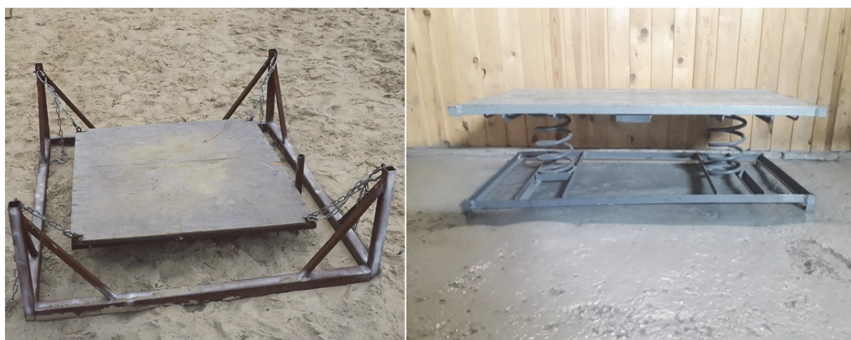
Рис. 33. Варианты изготовления неустойчивой платформы
