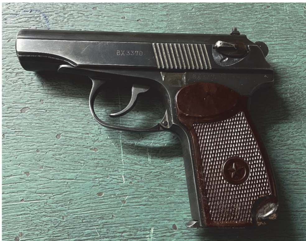
Рис. 40. Кнопка затворной задержки сломана
