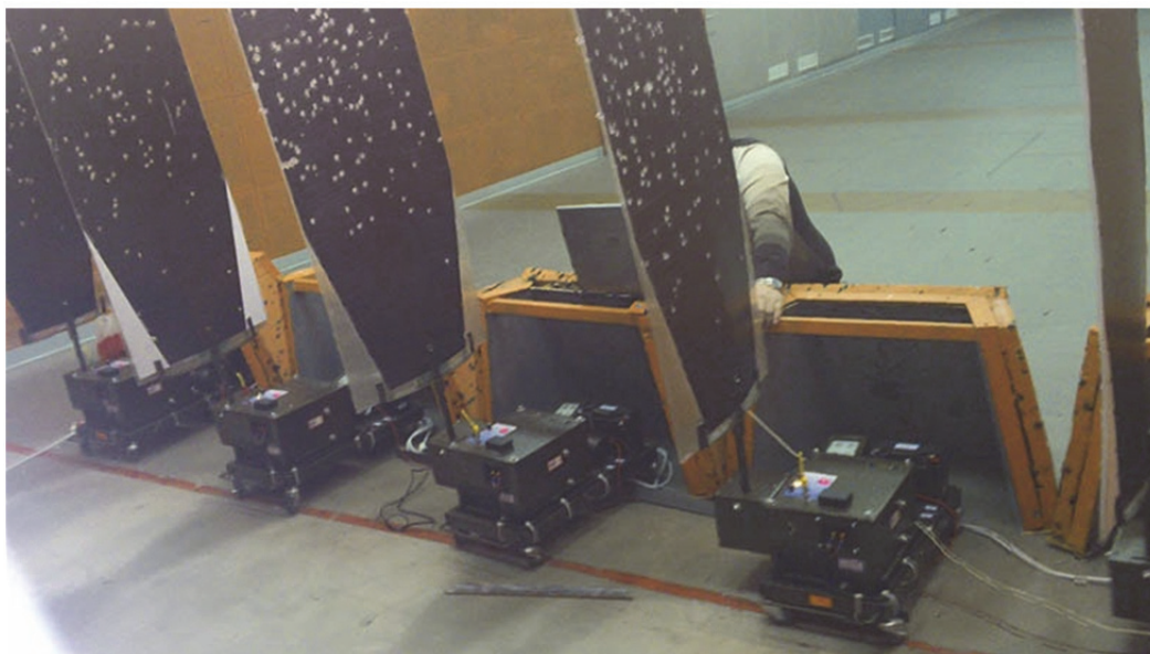
Рис. 65. Поворотные мишени в положении на ребро
