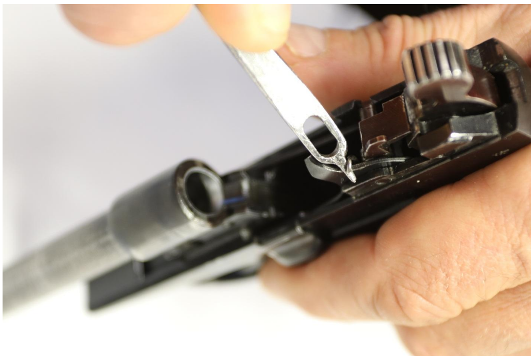
Рисунок 32. Опираение протирки выступом на отражатель
