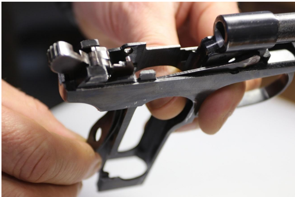
Рисунок 28. Удержание спускового крючка при постановке боевой пружины в пистолет
