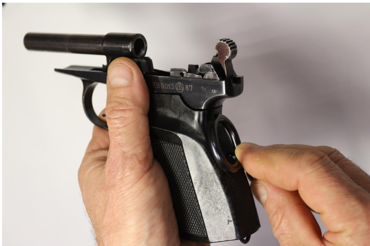
Рисунок 34. Откручивание винта рукоятки лезвием протирки
