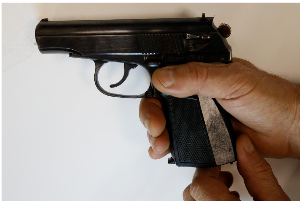
Рисунок 21. Сдвигание защелки магазина «щипком» средней фалангой с упором большого пальца в тыльную часть рукоятки
