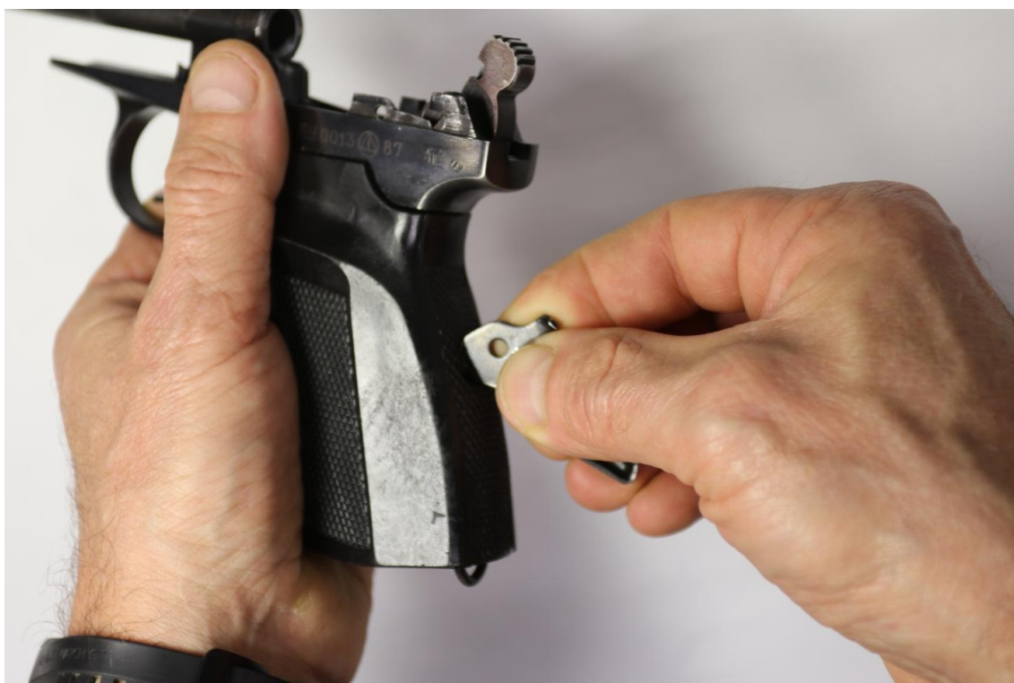
Рисунок 33. Откручивание винта рукоятки затворной задержкой
