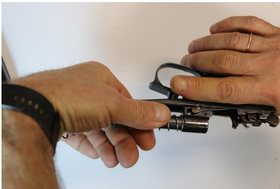
Рисунок 23. Постановка возвратной пружины при сборке пистолета
