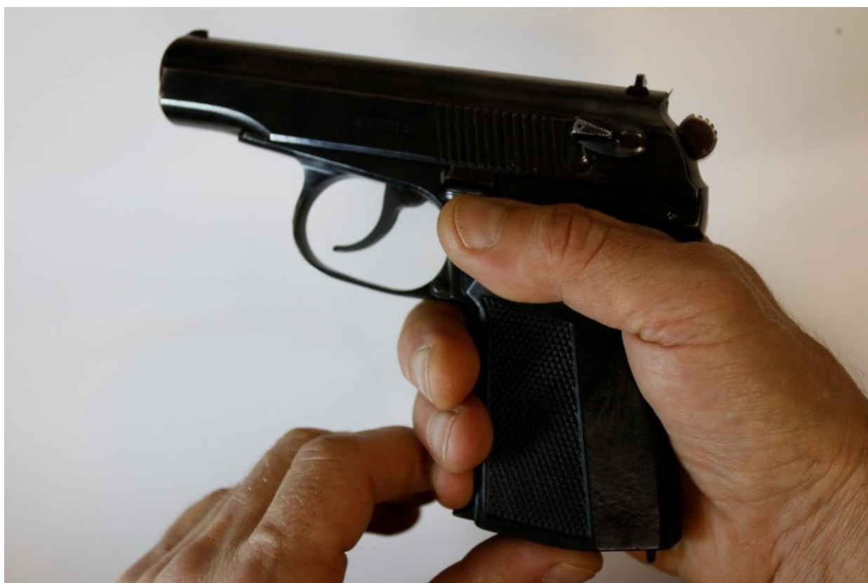
Рисунок 19. Извлечение магазина из основания рукоятки
