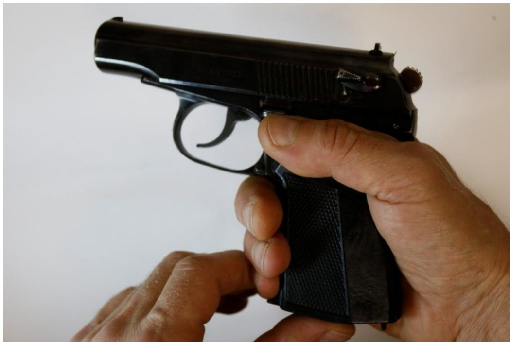
Рисунок 14. Извлечение магазина из основания рукоятки
