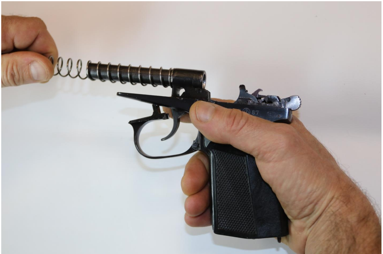
Рисунок 24. Неправильное действие, когда стягивают пружину за свободные от ствола витки
