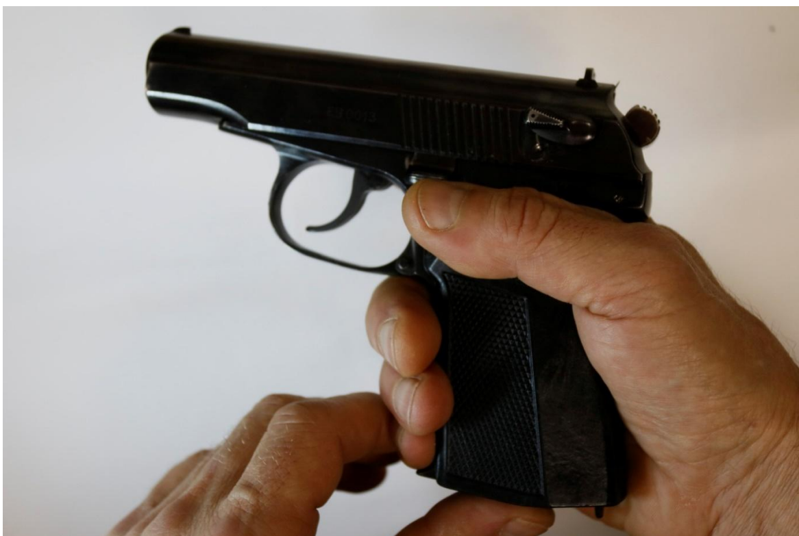
Рисунок 20. Сдвигание защелки магазина «тычком» ногтевой фалангой большого пальца
