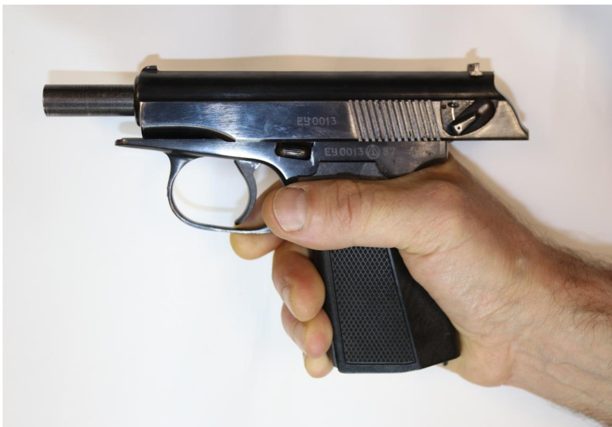
Рисунок 15. Удержание затвора на затворной задержке
