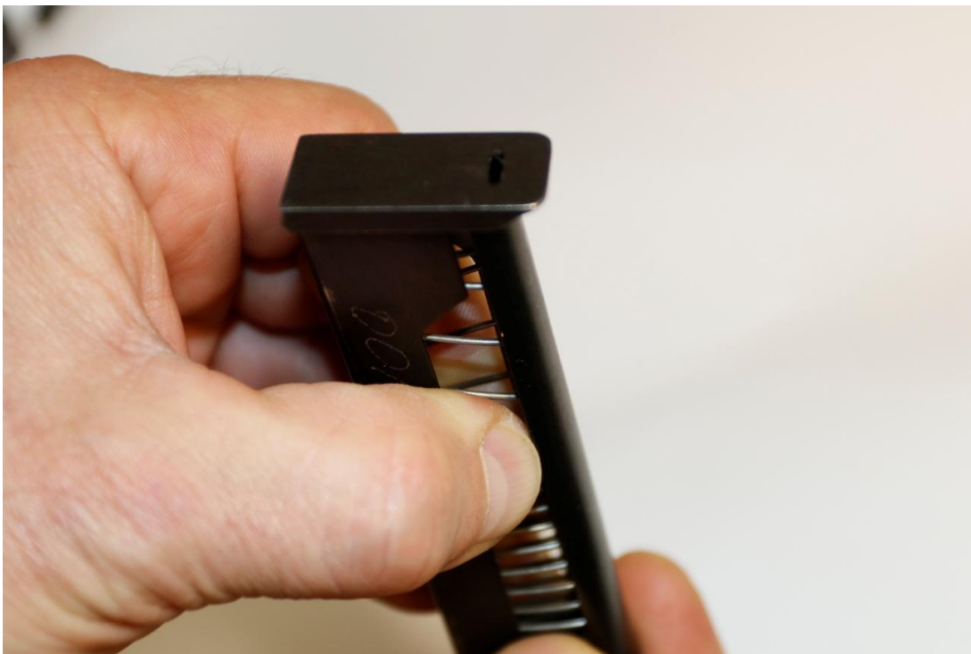
Рисунок 29. Снятие крышки магазина
