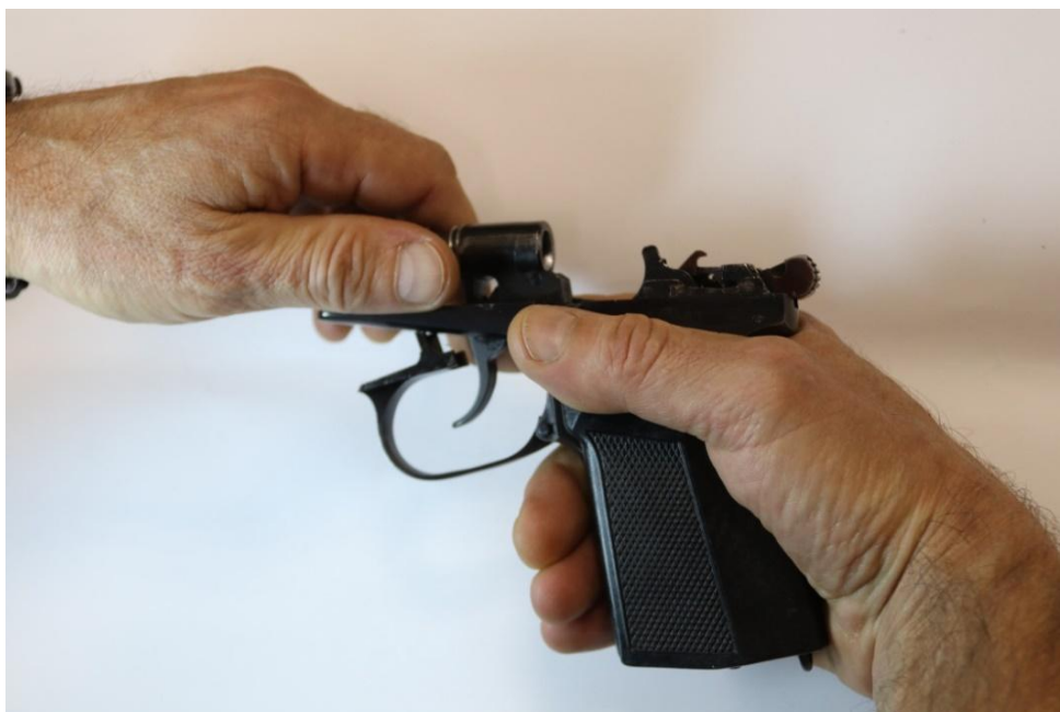
Рисунок 22. Снятие возвратной пружины
