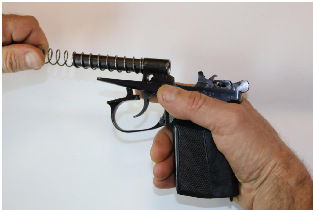
Рисунок 17. Снятие возвратной пружины со ствола
