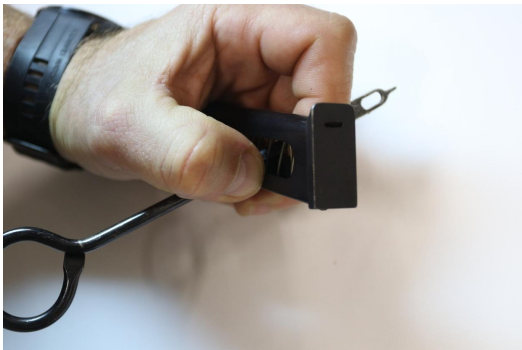
Рисунок 30. Безопасный способ сжатия пружины подавателя с использованием протирки
