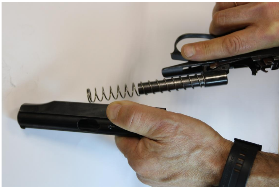
Рисунок 16. Отделение затвора от рамки
