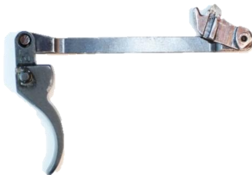
Рисунок 25. Правильное соединение между спусковой тягой с рычагом и спусковым крючком
