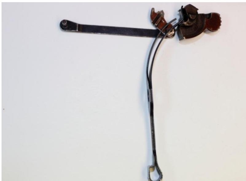
Рисунок 26. Правильное положение перьев боевой пружины
