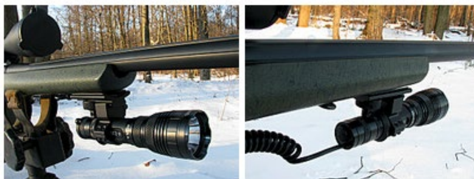
Рис.20. Крепление фонаря под ложе на антабочный винт
